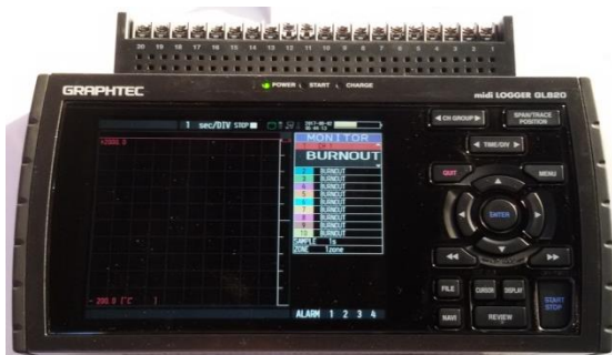
รูปที่ 3.5 ดาตาลีคเกอร์ midi LOGGER รุ่น GL 820
