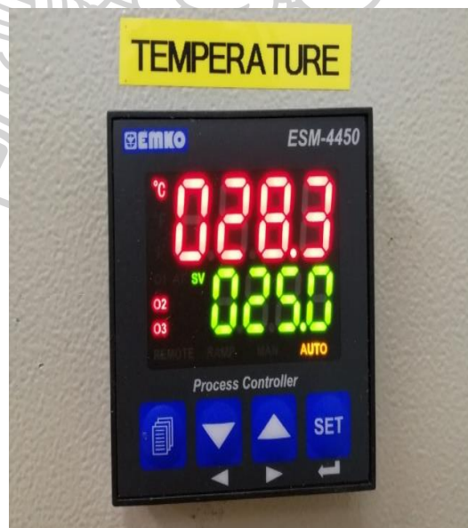
รูปที่ 3.17 อุปกรณ์ควบคุมอุณหภูมิรุ่น ESM-4450
