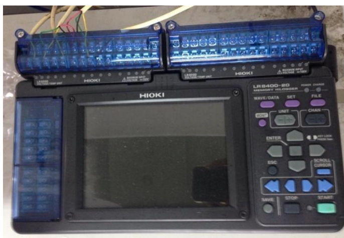
รูปที่ 3.25 เครื่องบันทึกข้อมูล (Data logger)
