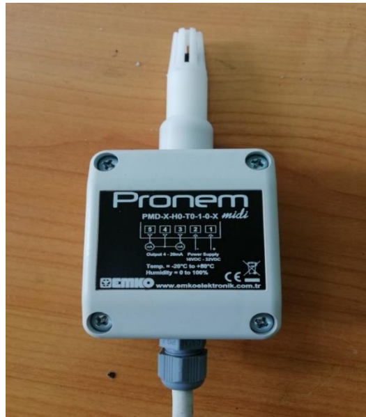
รูปที่ 3.19 เครื่องมือวัดอุณหภูมิและความชื้นอากาศ รุ่น Pronem
