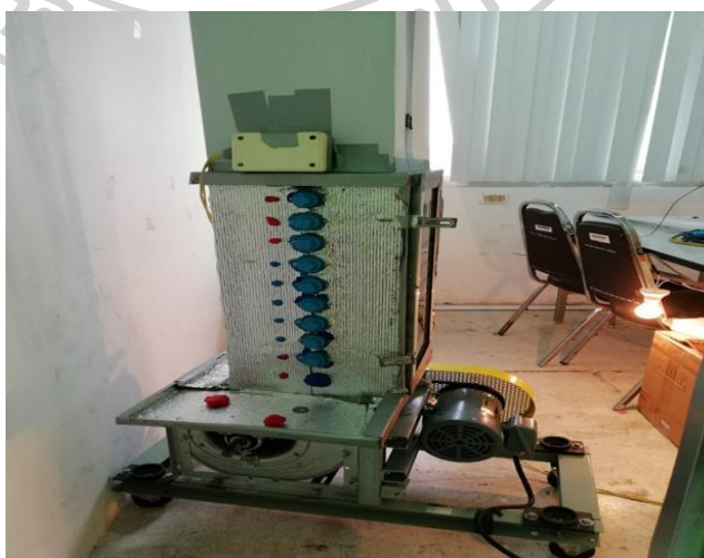
รูปที่ 3.12 เครื่องดูดความชื้นที่ใช้สารดูดความชื้นชนิดของแข็ง
