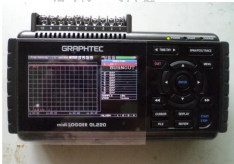
รูปที่ 3.5 ดาต้าล็อกเกอร์และสายวัดอุณหภูมิ
