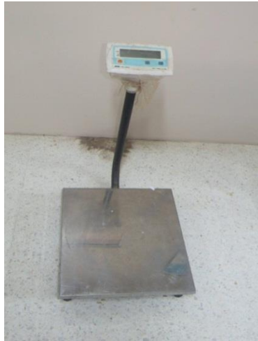
รูปที่ 3.6 เครื่องชั่งน้ำหนักดิจิทัลแบบตั้งพื้นช่วงการวัด 0-150 กิโลกรัม
