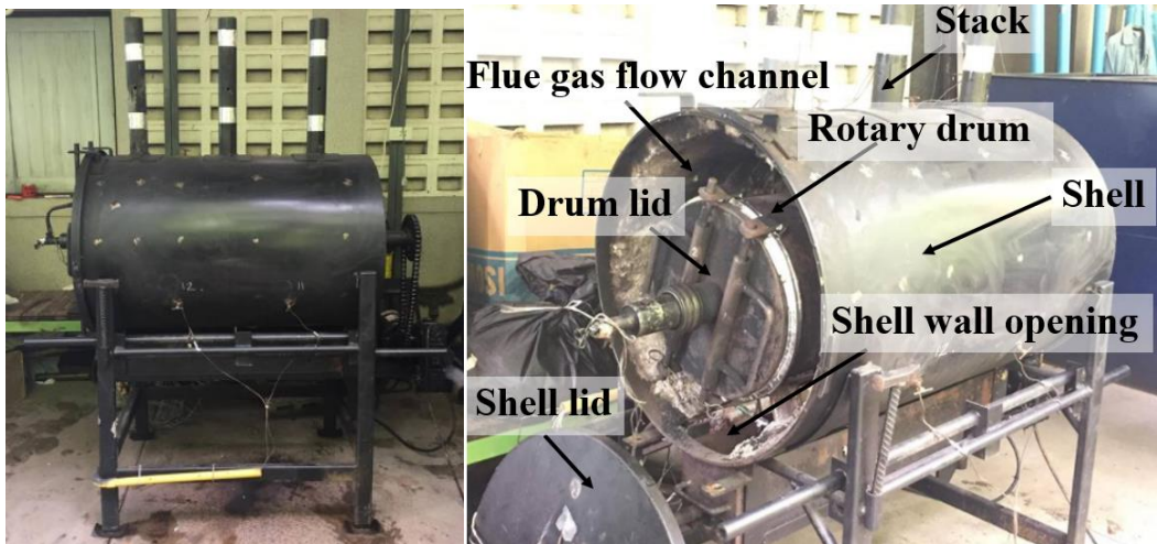
รูปที่ 3.4 เตาทอริไฟร์ชนิดดรัมหมุน
