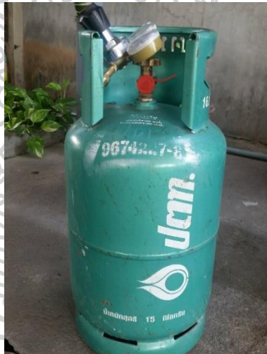
รูปที่ 3.7 ถังแก๊สปิโตเลียมเหลวพร้อมวาล์วปรับแรงดัน
