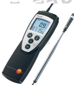
รูปที่ 3.3 เครื่องมือวัดความเร็วลมแบบเส้นขดลวดความร้อน
