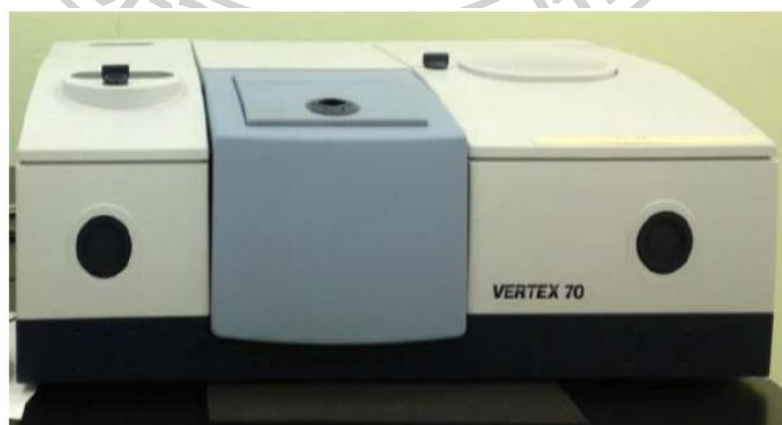
ภาพที่ 3.6 เครื่อง Fourier transform infrared spectrophotometer (Bruker Vertex70)
