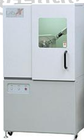
ภาพที่ 3.8 เครื่อง X-ray diffractometer (XRD-6100, SHIMADZU, Japan)
