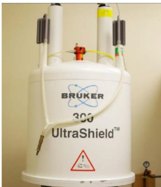
ภาพที่ 3.7 เครื่อง Nuclear magnetic resonance spectrometer (Bruker 300 Ultrashield)
