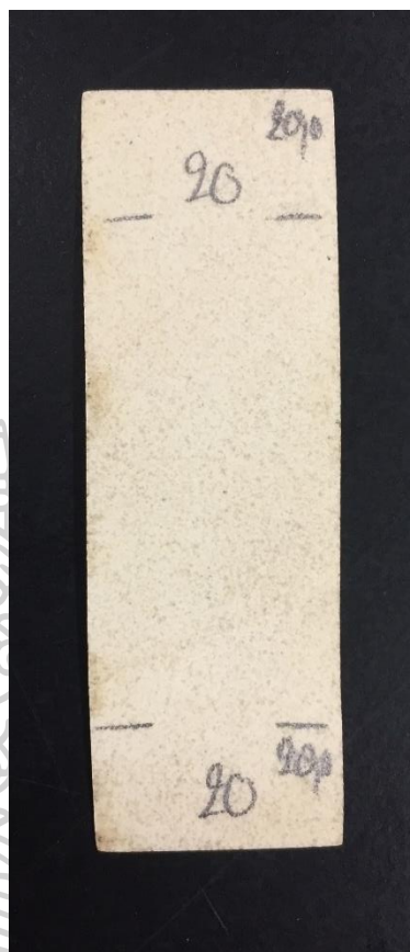
ภาพที่ 3.12 ตัวอย่างชิ้นงานสำหรับทดสอบความต้านทานต่อการดึงยืด (tensile test)
