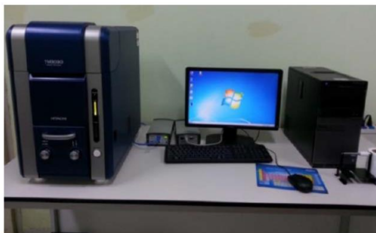
ภาพที่ 3.9 เครื่อง Tabletop Microscope รุ่น TM3030 (Hitachi, Japan)
