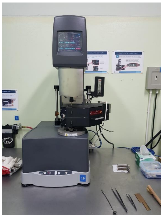
ภาพที่ 3.4 เครื่องทดสอบสมบัติการไหลแบบแผ่นคู่ขนาน
