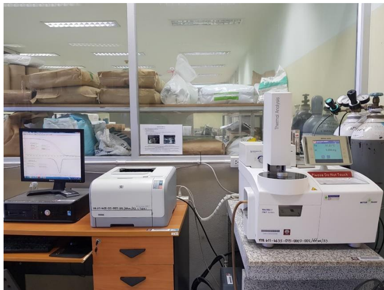
ภาพที่ 3.7 เครื่อง Thermogravimetric Analyzer (TGA)
