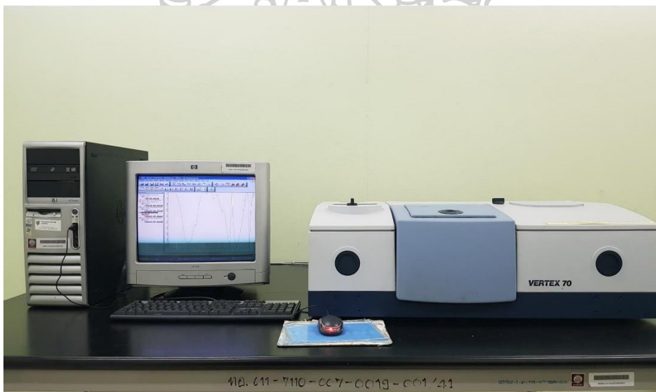
ภาพที่ 3.9 เครื่องอินฟราเรด สเปกโตรสโคปี (FTIR)
