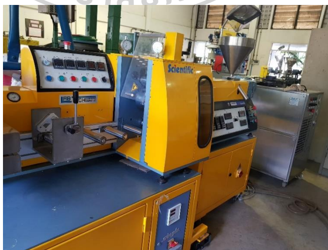
ภาพที่ 3.2 เครื่องหล่ออัดรีดแผ่นฟิล์ม (Cast film extruder)
