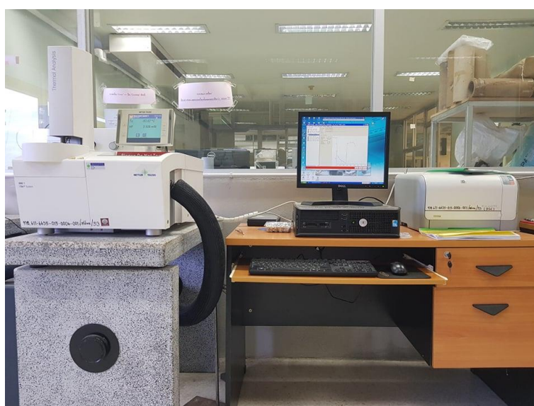
ภาพที่ 3.6 เครื่อง Differential Scanning Calorimeter (DSC)
