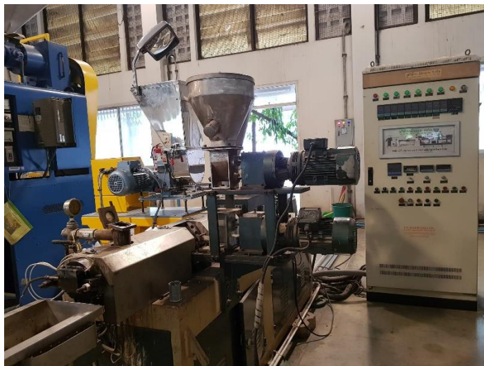
ภาพที่ 3.1 เครื่องอัดรีดแบบสองกรู (Twin screw extruder)
