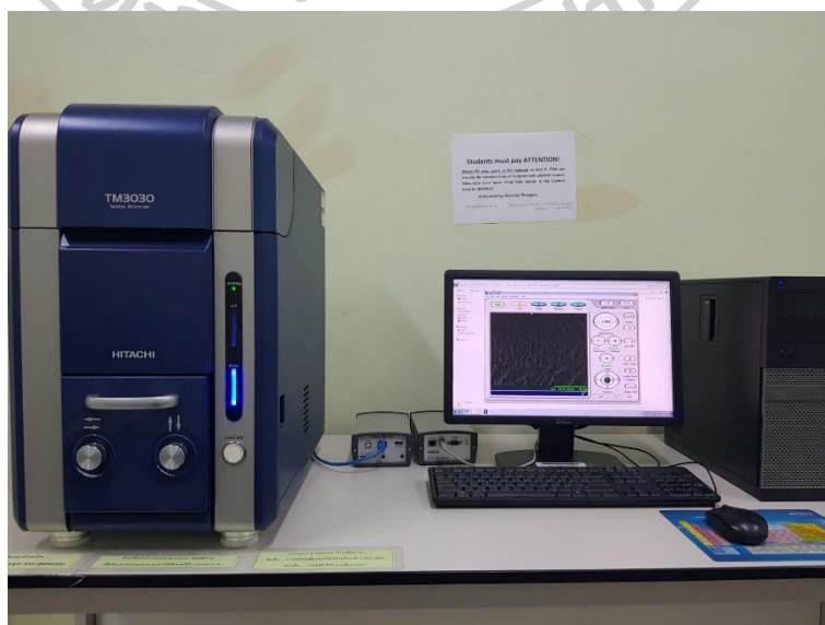
ภาพที่ 3.8 กล้องจุลทรรศน์อิเล็กตรอนแบบส่องกราด (SEM)
