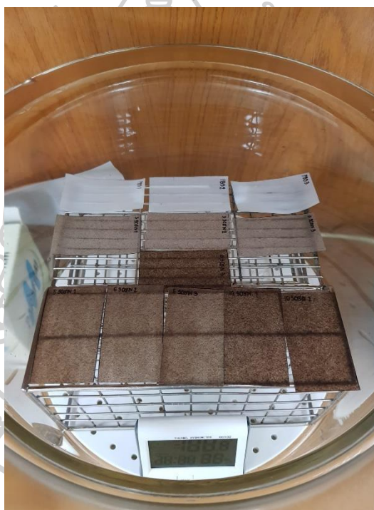
ภาพที่ 3.10 ชิ้นงานและการทดสอบความสามารถในการดูดซับความชื้นของแผ่นฟิล์มคอมพอสิต
