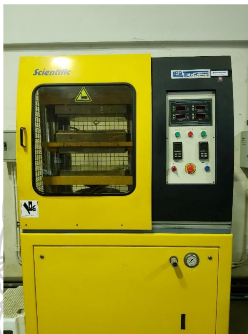
ภาพที่ 3.3 เครื่องขึ้นรูปด้วยการกดอัด (Compression molding)
