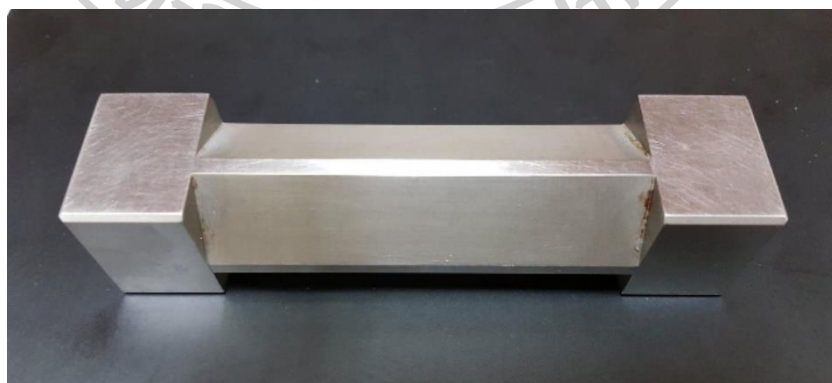
ภาพที่ 3-7 อุปกรณ์เคลือบฟิล์มที่ใช้ในงานวิจัย
