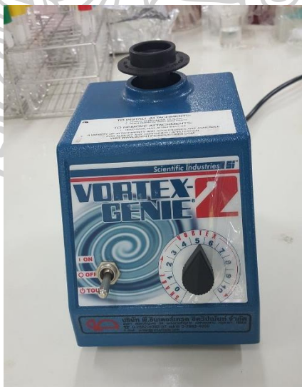
ภาพที่ 3-17 เครื่องเขย่าสาร (Vortex Mixer) ที่ใช้ในงานวิจัย
