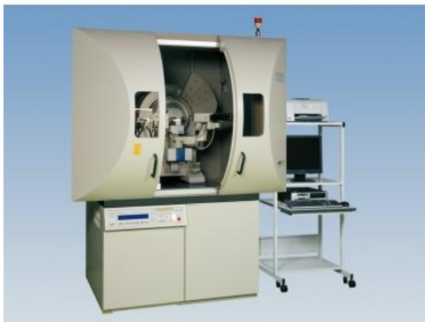
ภาพที่ 3-10 เครื่องมือสำหรับการศึกษาความเป็นผลึกด้วยเทคนิค X-Ray Diffraction Analysis ที่ใช้ในงานวิจัย [19]
