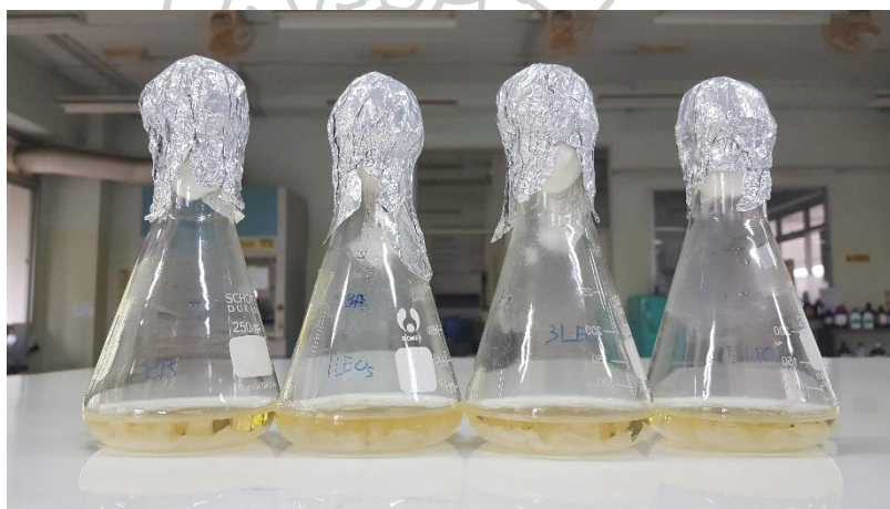
ภาพที่ 3-34 อาหารเลี้ยงเชื้อชนิดเหลวพร้อมฟิล์มตัวอย่างและเชื้อแบคทีเรีย
