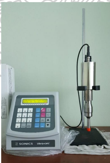
ภาพที่ 3-3 เครื่องกำเนิดคลื่นเสียงความถี่สูงที่ใช้ในงานวิจัย
