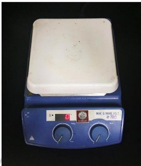
ภาพที่ 3-2 เครื่องกวนสารละลายพร้อมเตาให้ความร้อนที่ใช้ในงานวิจัย
