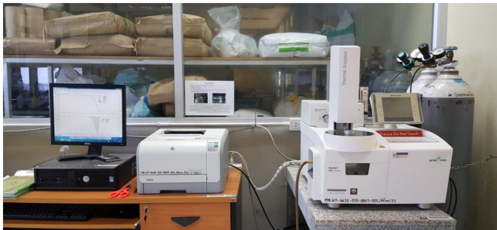
ภาพที่ 3-12 เครื่องมือสำหรับการศึกษาเสถียรภาพทางความร้อนที่ใช้ในงานวิจัย
