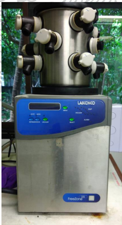
ภาพที่ 3-5 เครื่องทำแห้งแบบแช่เยือกแข็งที่ใช้ในงานวิจัย
