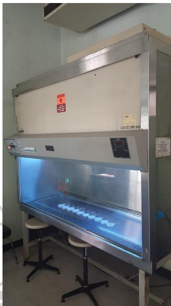
ภาพที่ 3-16 เครื่องฆ่าเชื้อด้วยแสงอัลตราไวโอเล็ตที่ใช้ในงานวิจัย
