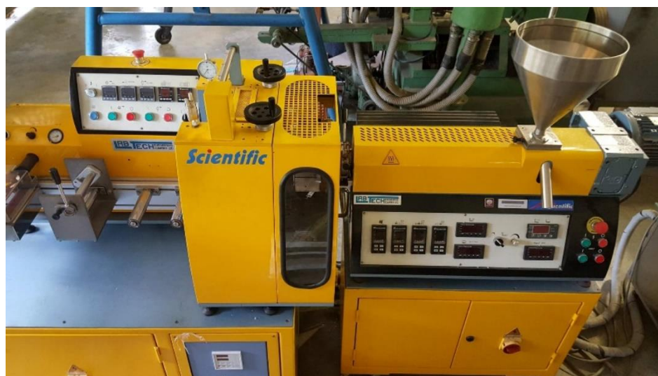
ภาพที่ 3-6 เครื่องหล่ออัดรีดแผ่นฟิล์มที่ใช้ในงานวิจัย
