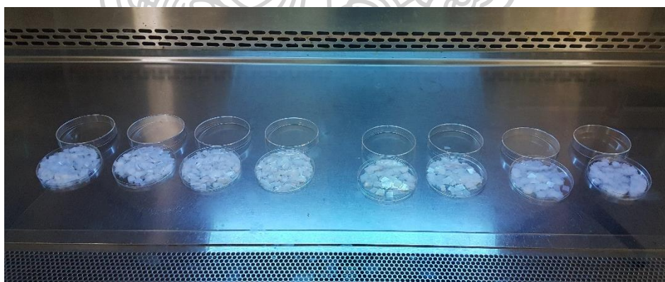
ภาพที่ 3-33 การฆ่าเชื้อฟิล์มตัวอย่างด้วยแสงอัลตราไวโอเลต (Ultraviolet light)
