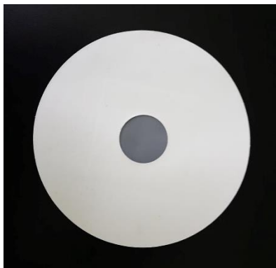
ภาพที่ 3-24 ตัวอย่างสำหรับการทดสอบสมบัติการต้านทานการซึมผ่านแก๊ส
