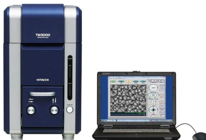
ภาพที่ 3.7 กล้องจุลทรรศน์อิเล็กตรอนชนิดส่องกราด (SEM) [42]
