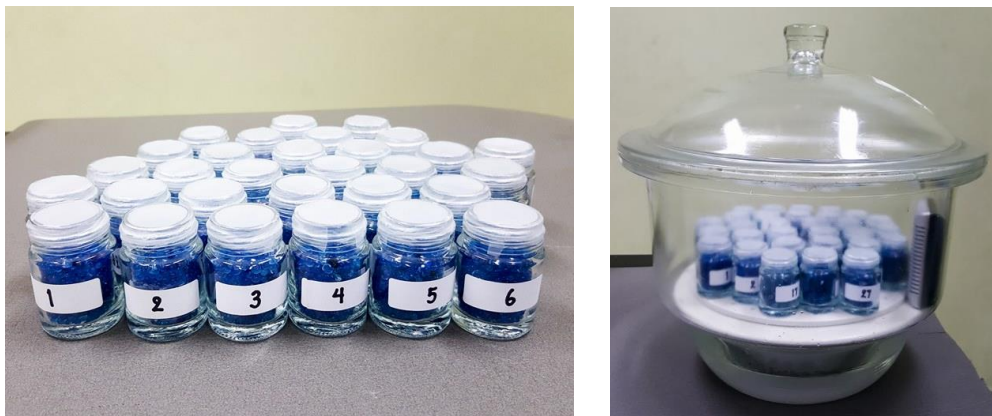
ภาพที่ 3.10 फिल्मพอลิเมอร์ผสมที่ติดบนปากขวดทดสอบ (ภาพซ้าย) และนำขวดทดสอบไปวางไว้ใน Desiccator ภายใต้สภาวะที่ทดสอบ (ภาพขวา)
