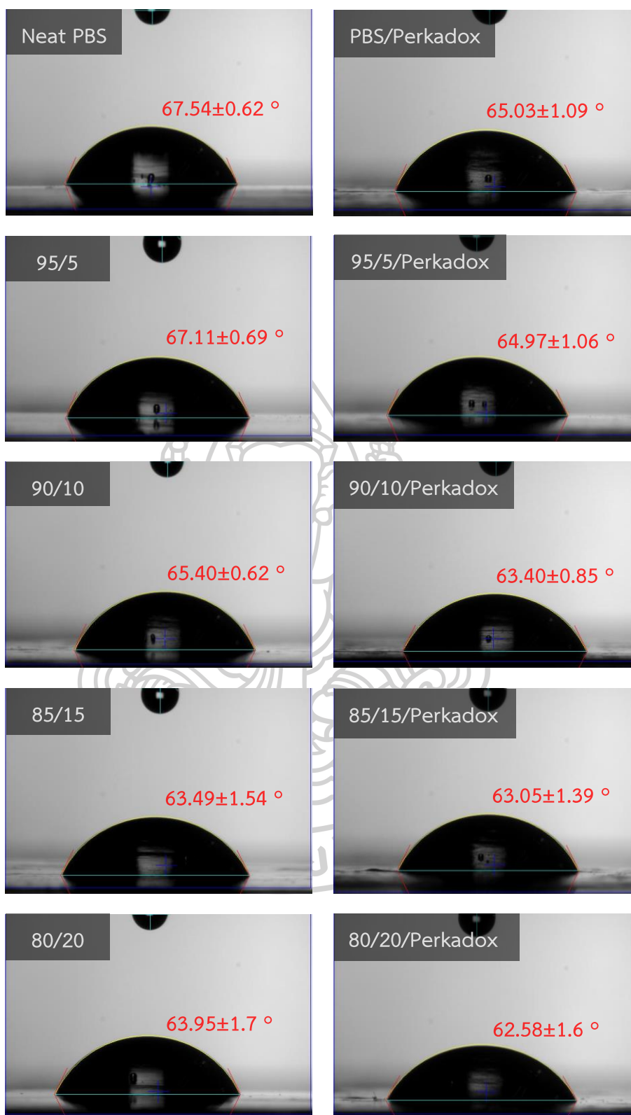
ภาพที่ 4.16 ค่ามุมสัมผัสผิวน้ำของฟิล์มพอลิเมอร์ผสมระหว่าง PBS/PBAT ที่ไม่เติมและเติม Perkadox
