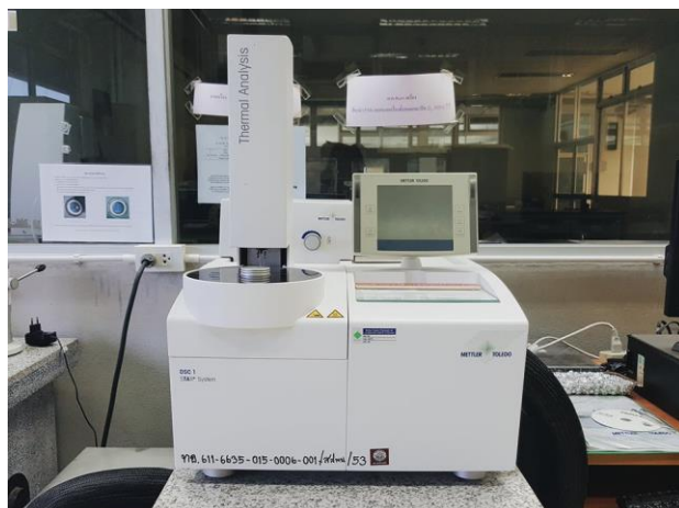
ภาพที่ 3.8 เครื่องมือทดสอบสมบัติทางความร้อน Differential scanning calorimeter (DSC)
