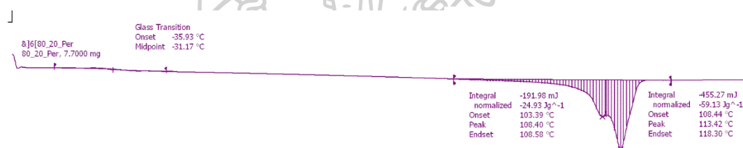
ภาพผนวก ข.1 ภาพประกอบการคำนวณเปอร์เซ็นต์ผลึกของ PBS ในฟิล์มพอลิเมอร์ผสม
