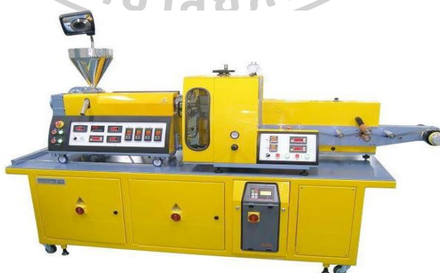
ภาพที่ 3.2 เครื่องหลอมอัดรีดแผ่นฟิล์มที่ใช้ในการขึ้นรูปฟิล์มพอลิเมอร์ผสมสีต่างๆ [40]
