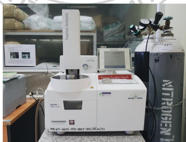
ภาพที่ 3.9 เครื่องมือทดสอบเสถียรภาพทางความร้อน Thermogravimetric Analyzer (TGA)
