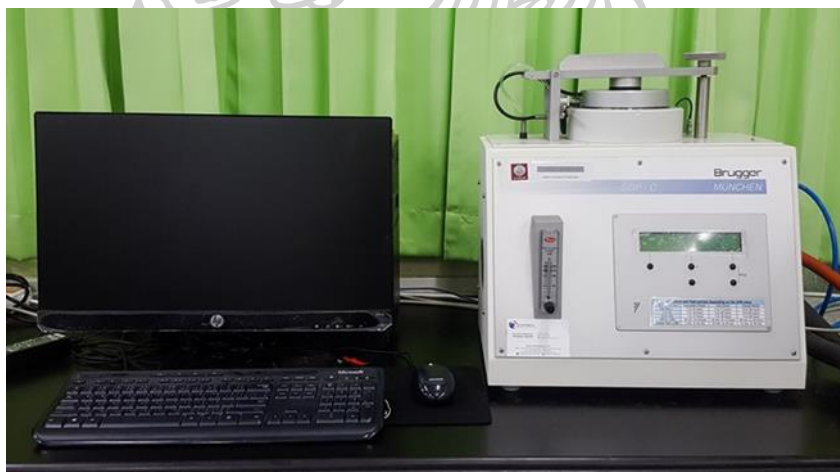
ภาพที่ 3.12 เครื่องทดสอบการซึมผ่านของแก๊สออกซิเจน ของบริษัท Bruker feinmechanik จำกัด ประเทศเยอรมัน
