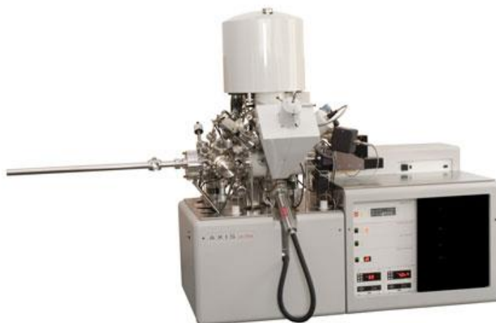
ภาพที่ 3.14 เครื่องสเปกโตรสโคปีของอนุภาคอิเล็กทรอนิกส์ที่ถูกปลดปล่อยด้วยรังสีเอกซ์ (X-ray photoelectron spectroscopy, XPS) [46]
