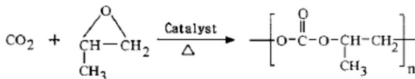
ภาพที่ 1.2 ปฏิกิริยาการสังเคราะห์ Poly (propylene carbonate) จาก CO 2 [1]
