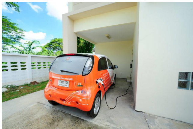
ภาพที่ 2.13 การประจุไฟแบบปกติ (Normal Charger) (ที่มา : http://www.thairath.co.th/content/354023 )
