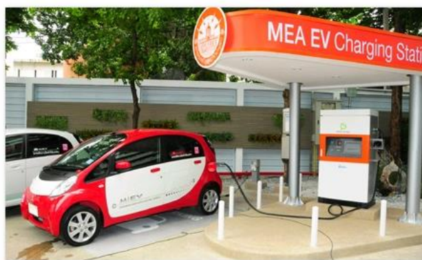
ภาพที่ 2.14 การประจุไฟแบบเร็ว (Quick Charger) (ที่มา : http://www.autospy.in.th )
