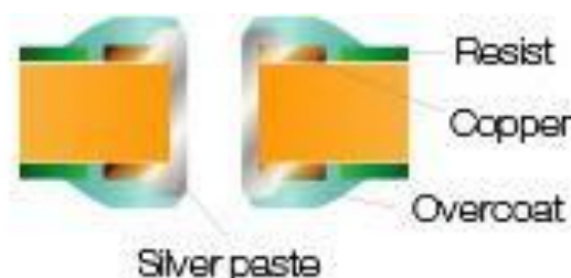
ภาพที่ 24 แผ่นวงจรพิมพ์ชนิดสองหน้าแบบพิมพ์หมึกที่เป็นตัวนำไฟฟ้าชนิด Silver
