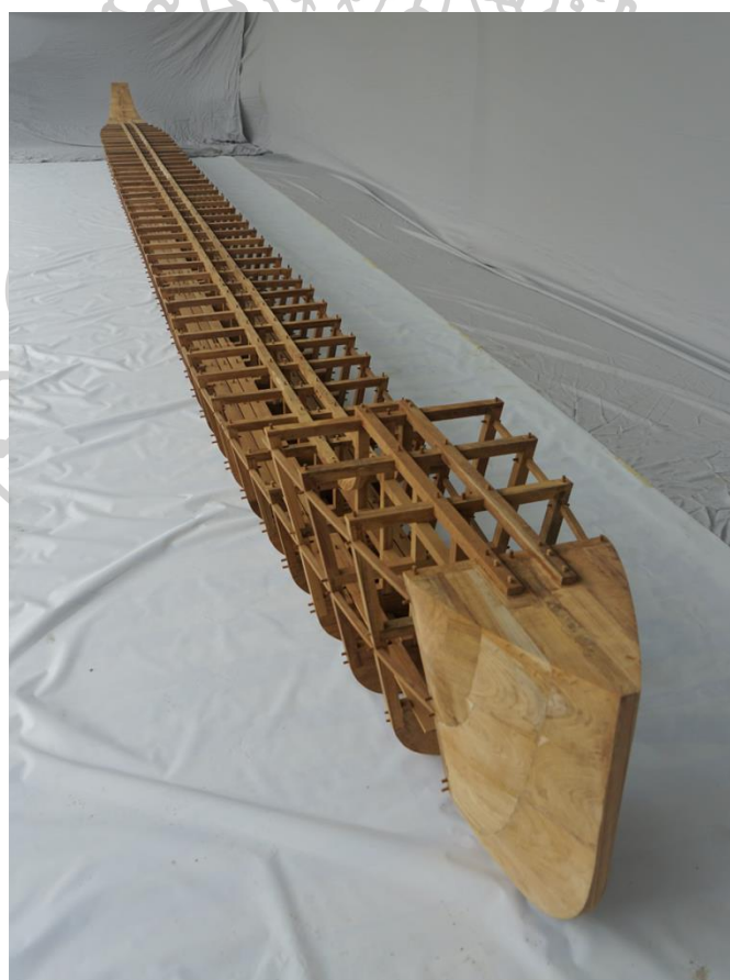
ภาพที่ 139 “เรือพืฆาด หมายเลข 5” (มุมมองด้านบน) ไม้สัก ขนาด 60 x สูง 80 เซนติเมตร ความยาว 10.80 เมตร
