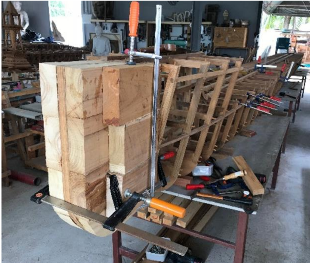
ภาพที่ 203 การต่อประกบไม้ด้วยกาว ที่มา: ผู้วิจัยสร้างสรรค์
