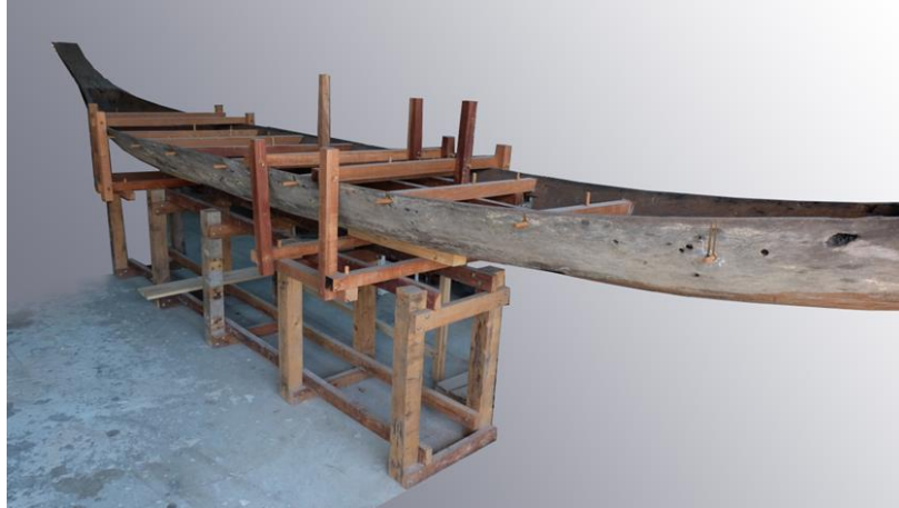
ภาพที่ 80 ภาพผลงานการ “ซ่อมแซม” (ภาพเรือหางาย 1) ขนาดความกว้าง 1.10 เมตร ยาว 7.80 เมตร วัสดุไม้ตะเคียนและไม้เนื้อแข็ง เรือเก่าโบราณ ที่มา: ผู้วิจัยสร้างสรรค์
