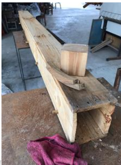
ภาพที่ 143 กล่องท่อสำหรับนึ่งไม้ ขนาดกล่อง 5 x 5 นิ้ว ความยาว 3.20 เมตร ที่มา: ผู้วิจัยสร้างสรรค์
