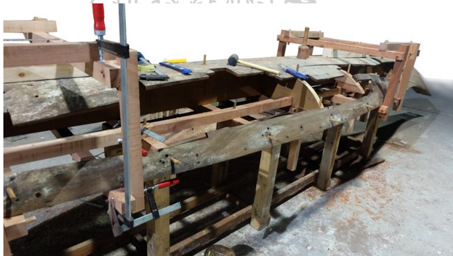
ภาพที่ 79 ภาพผลงานการ “ซ่อมแซม” (ภาพเรือคว่ำ 1) ขนาดความกว้าง 1.10 เมตร ยาว 7.80 เมตร วัสดุไม้ตะเคียนและไม้เนื้อแข็ง เรือเก่าโบราณ ที่มา: ผู้วิจัยสร้างสรรค์
