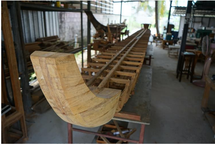
ภาพที่ 136 “เรือพิฆาต หมายเลข 5” แสดงมุมมองด้านท้ายไม้สัก ขนาด 60 x สูง 80 เซนติเมตร ความยาว 10.80 เมตร ที่มา: ผู้วิจัยสร้างสรรค์
