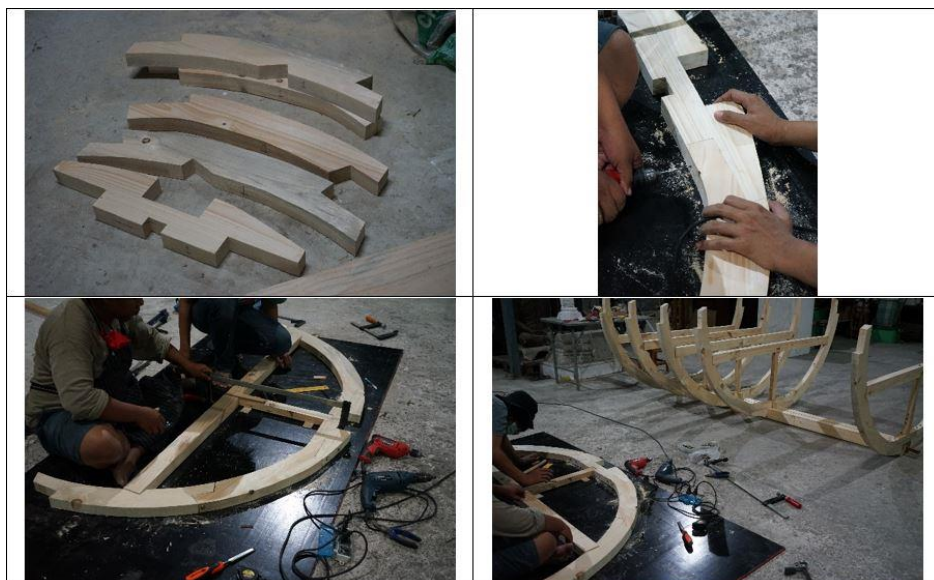
ภาพที่ 92 ขั้นตอนการสร้างประกอบชิ้นส่วนผลงาน “กระดุงเรือ หมายเลข 12/12” ที่มา: ผู้วิจัยสร้างสรรค์
