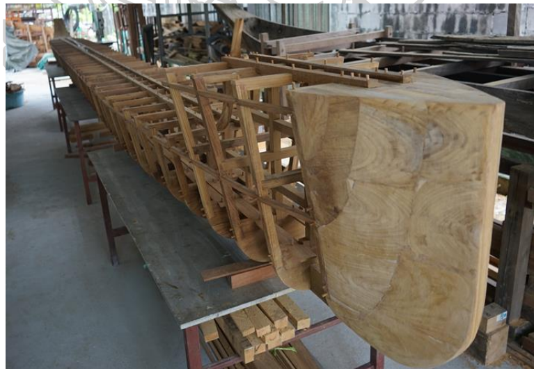
ภาพที่ 135 “เรือพิฆาต หมายเลข 5” แสดงมุมมองด้านหัวไม้สัก ขนาด 60 x สูง 80 เซนติเมตร ความยาว 10.80 เมตร ที่มา: ผู้วิจัยสร้างสรรค์
