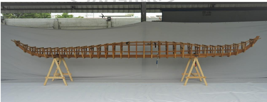
ภาพที่ 119 "เรือพิฆาต หมายเลข 3" (ด้านข้าง) ความยาว 6.5 เมตร วัสดุไม้ ที่มา: ผู้วิจัยสร้างสรรค์
