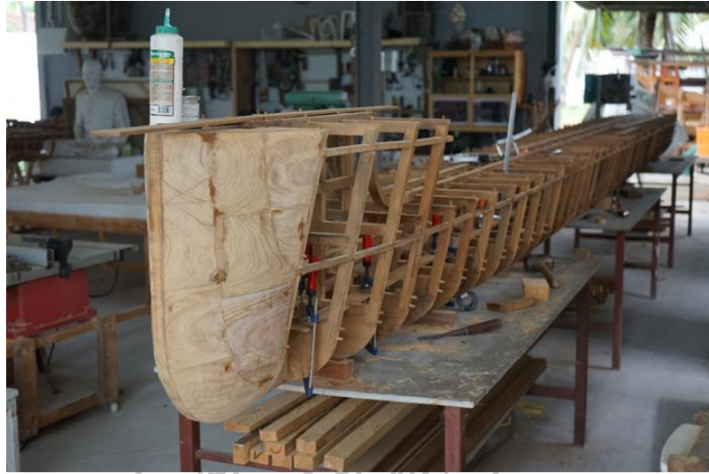
ภาพที่ 134 ภาพแสดงการแกะไม้ส่วนหัวด้วยการประกอบชิ้นส่วนอัดด้วยกาว ที่มา: ผู้วิจัยสร้างสรรค์
