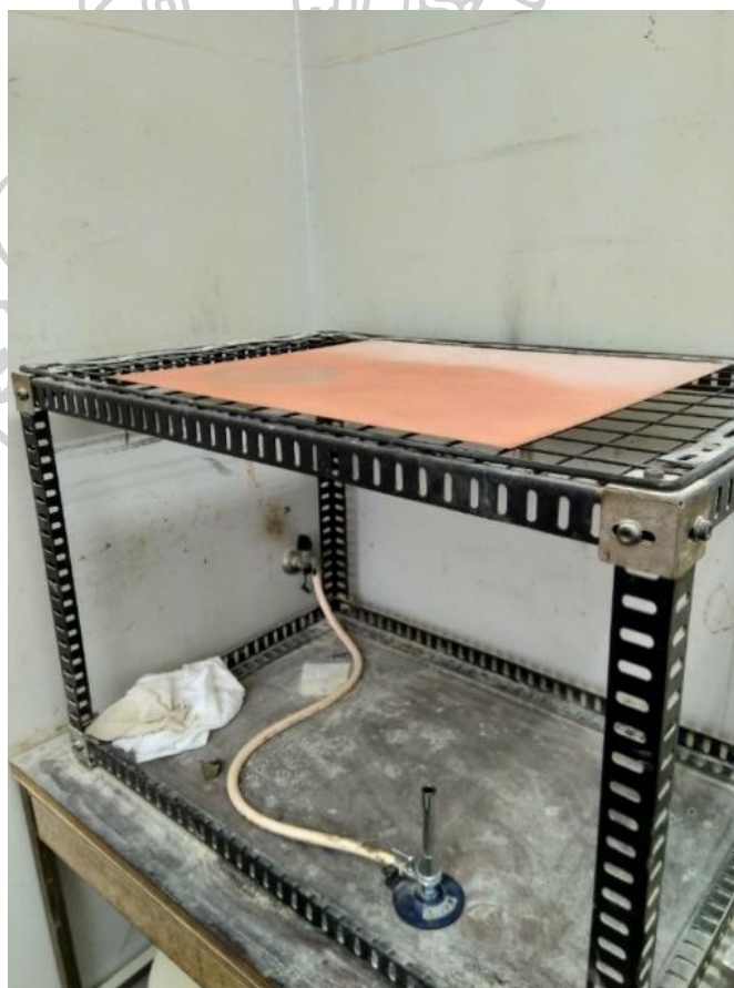
ภาพที่ 20 ภาพขั้นตอนการอย่างผงยางสนเพื่อให้ “ยางสน” ติดลงบนผิวหน้าของเพลทแม่พิมพ์
