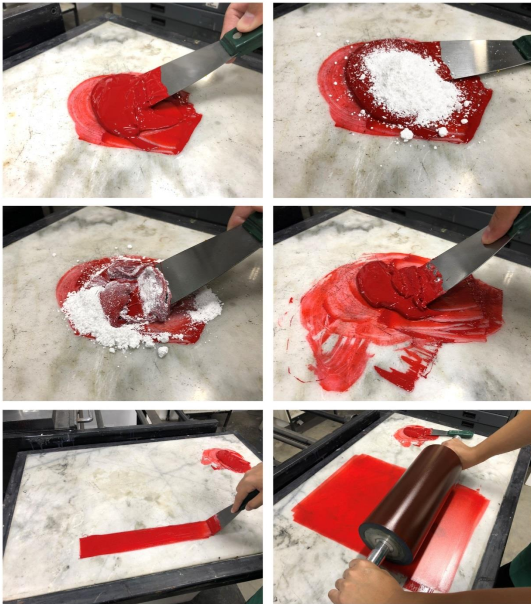
ภาพที่ 33 ภาพแสดงการเตรียมหมึกพิมพ์และลูกกลิ้งสำหรับกระบวนการพิมพ์
