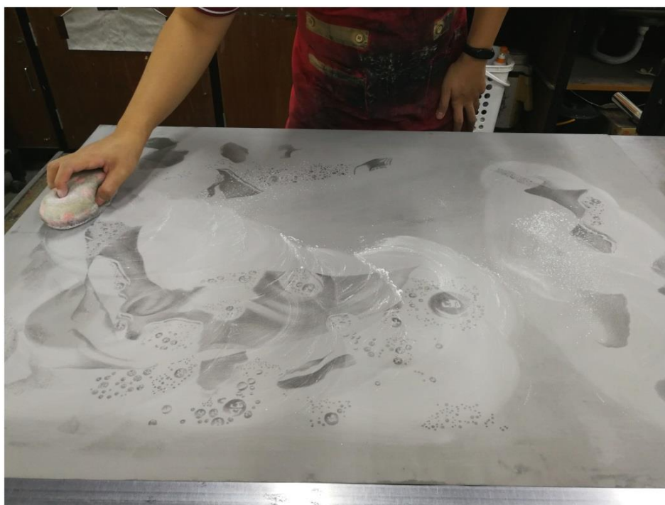
ภาพที่ 27 ภาพแสดงการลูบแป้งฝุ่น (talcum) ก่อนการเคลือบกาวบนเพลทแม่พิมพ์
