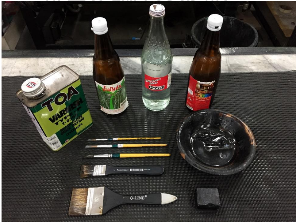
ภาพที่ 38 ภาพถ่ายอุปกรณ์ในการเคลือบหน้าแม่พิมพ์
