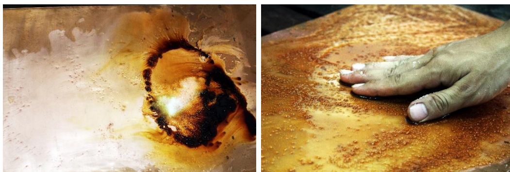
ภาพที่ 24 ภาพขั้นตอนการล้างทำความสะอาดหน้าแม่พิมพ์โดยใช้เกลือ น้ำส้มสายชู ซีอิ๊วขาว
