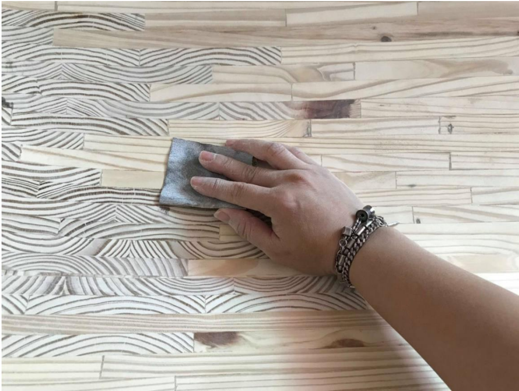
ภาพที่ 35 ภาพขั้นตอนการขัดแต่งเก็บรายละเอียดผลงานรอบสุดท้ายด้วยมือ
