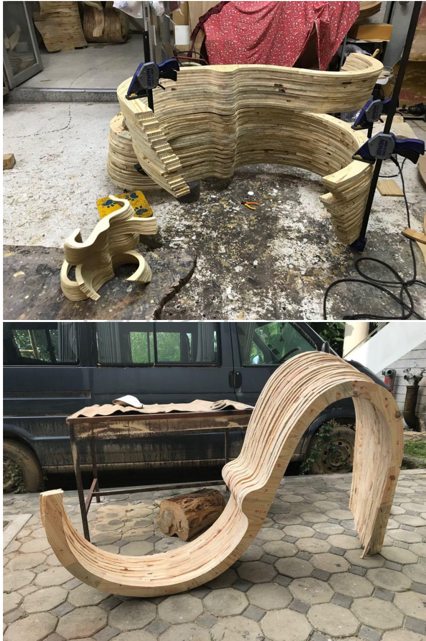
ภาพที่ 28 ภาพชิ้นส่วนของผลงานจากการเปลาะไม้ด้วยการใช้กาวย่วมกับเดือยกลม
