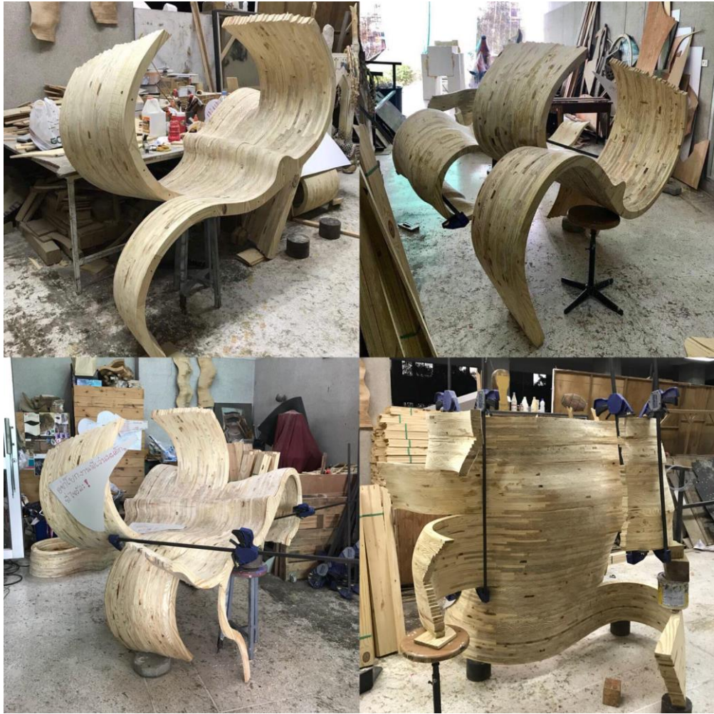
ภาพที่ 32 ภาพขั้นตอนการประกอบชิ้นส่วนของผลงาน
