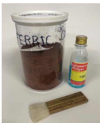
ภาพที่ 33 ภาพอุปกรณ์ในการทำกระดาษลอกแบบ ผงเฟอร์ริกออกไซด์ ผสมกับแอลกอฮอล์
