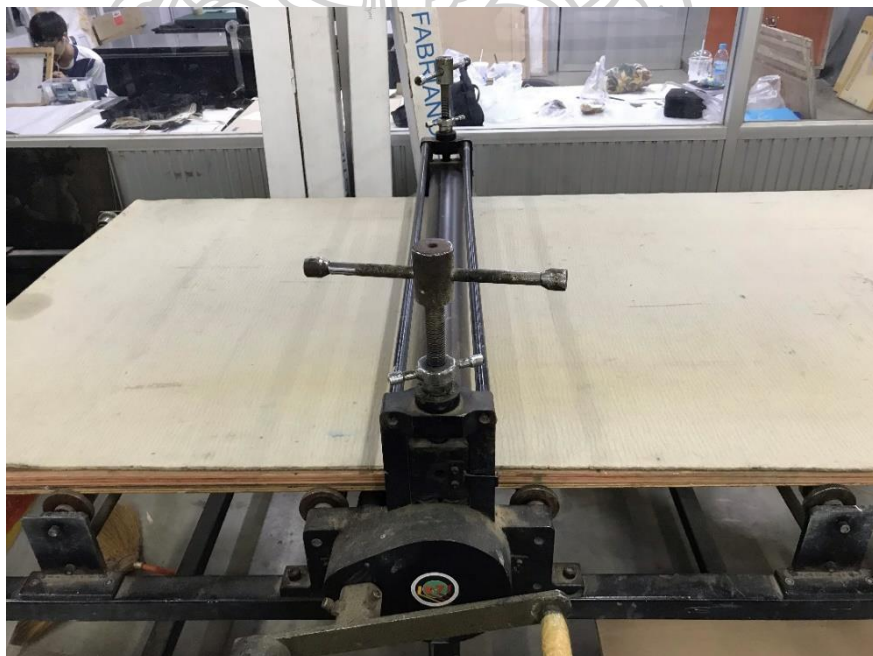
ภาพที่ 28 ภาพแท่นพิมพ์สำหรับกระบวนการภาพพิมพ์แกะไม้ (Woodcut Press)
