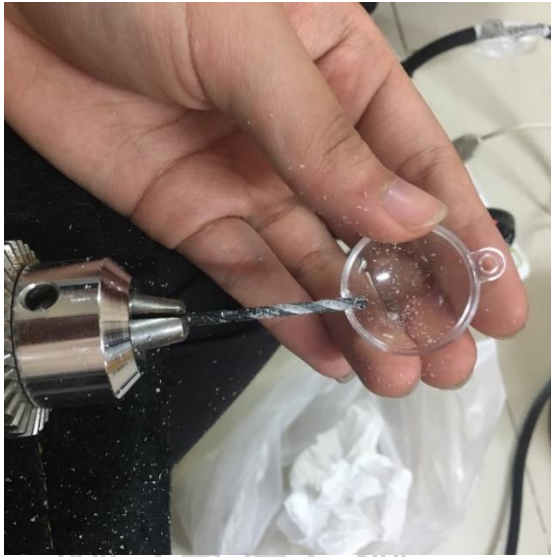
ภาพที่ 51 การเจาะด้านท้ายของลูกบอลทรงกลมใสเพื่อให้ใส่ดอกหญ้าเข้าไปได้และมีอากาศถ่ายเท
