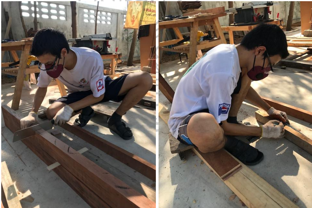
ภาพที่ 146 ภาพการบากไม้โดยใช้เลื่อยฉลุ ถ่ายโดย : ธนพล หมอกยา
