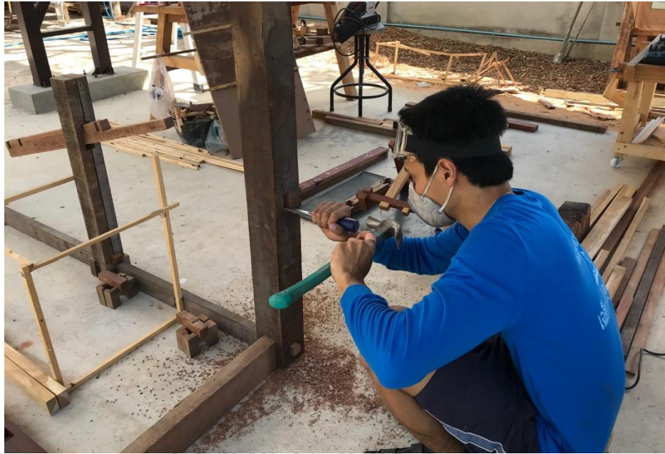
ภาพที่ 147 การเซาะร่องเจาะรูไม้ด้วยสิ่วกับค้อน ถ่ายโดย : ธนพล หมอกยา
