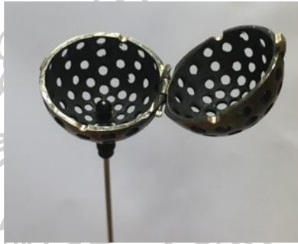
ภาพที่ 6.18 การเลเซอร์ลวดสแตนเลสให้ยึดติดกับชิ้นงาน ชิ้นงานที่ประกอบสำเร็จแล้ว
