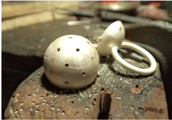
ภาพที่ 6.13 เจาะรูสำหรับให้แสงลอด ตามที่ออกแบบไว้ บางชิ้นงาน เมื่อประกอบกับตัวเรือนแหวนหรือกำไลแล้ว นำไปลงดำนบนพื้นผิวงานให้ สวยงาม ประกอบชิ้นงานให้เรียบร้อย
