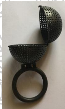
ภาพที่ 6.14 ชิ้นงานที่ลงดำแล้ว ส่วนของตัวเรือนที่ทำจากสเตนเลส นำลวดสเตนเลสมาฉนวนให้เป็นสปริงขนาดเส้นผ่านศูนย์กลางตามที่กำหนดไว้ จากนั้น นำมาเลื่อยให้เป็นห่วงวงกลม นำมาเลื่อยตัดให้ได้ตามแบบ หรือระยะห่างตามแบบ
