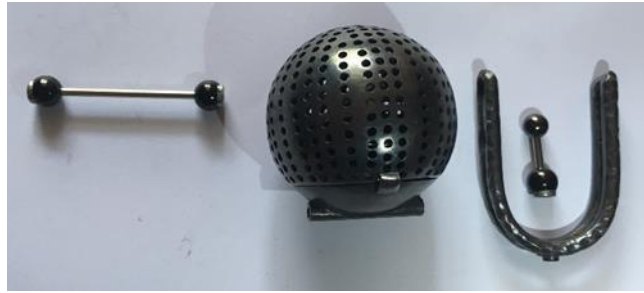
ภาพที่ 6.17 เม็ดสแตนเลสที่ฝังแม่เหล็ก ก่อนนำไปประกอบกับชิ้นส่วนอื่นๆที่เตรียมไว้ ชิ้นงานที่เป็นลวดยาว ใช้ลวดสแตนเลสขนาด 1 มิลลิเมตร เลเซอร์ลวด ติดกับชิ้นงานที่เป็นเงินโดยใช้น้ำประสานเงินเป็นตัวประสาน
