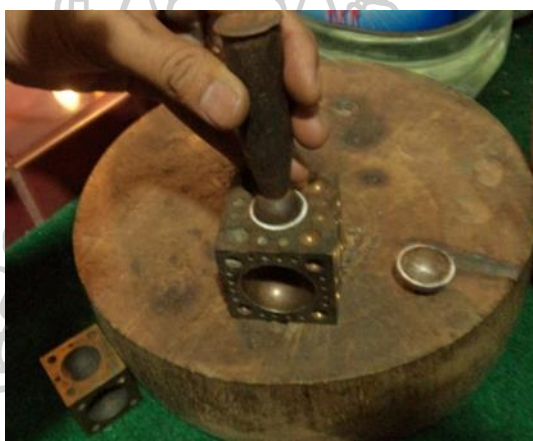
ภาพที่ 6.9 การเคาะขึ้นรูปให้เป็นทรงกลม เมื่อเคาะขึ้นรูปเป็นทรงครึ่งวงกลมแล้ว นำทั้ง 2 ชิ้นมาประกบเป็นชิ้นงานโดยนำสองชิ้น มาประกบกันให้พอดี ได้ทรงกลมที่สวยงาม
