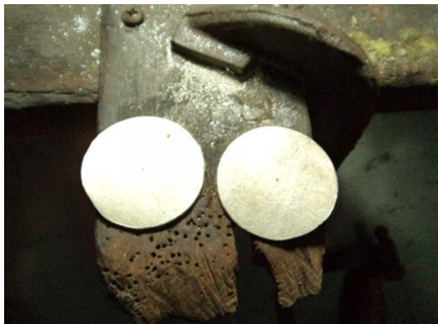
ภาพที่ 6.8 ฉลุแผ่นเงินให้เป็นรูปวงกลม เคาะขึ้นรูปให้เป็นทรงกลม เคาะจนได้ขนาดรูปทรงครึ่งวงกลม และได้จำนวนที่ต้องการ
