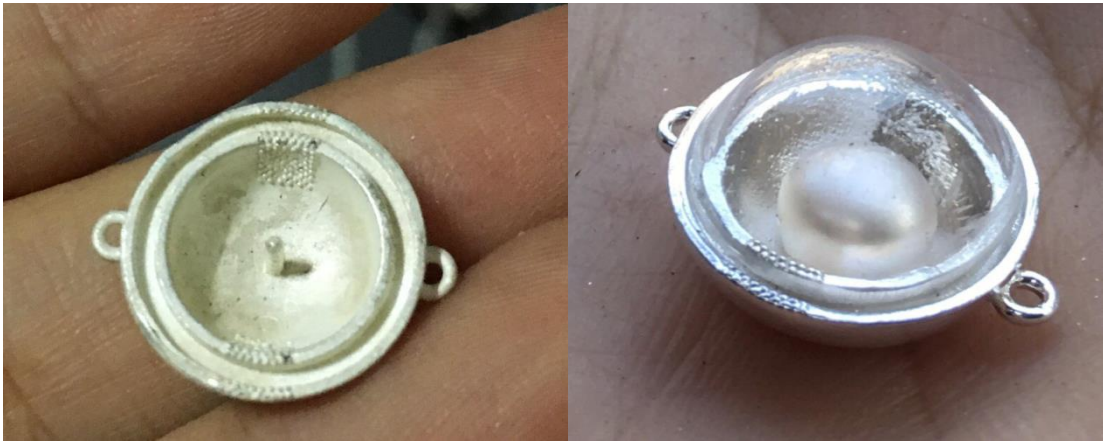
ภาพที่ 15 ชิ้นงานหล่อฐานไข่มุก
