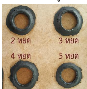
ภาพที่ 63 ภาพแสดงการทดลองหล่อเรซินชนิดใส ที่ผสมตัวเร่งปฏิกิริยาต่างกัน
