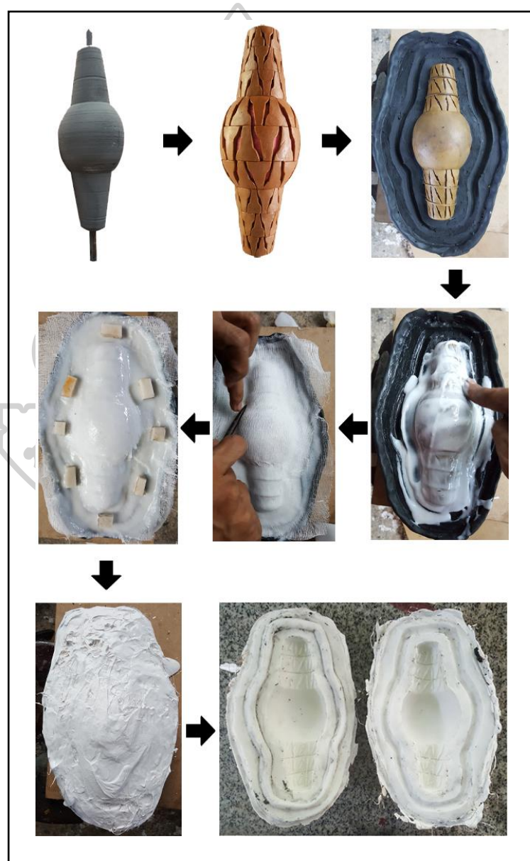
ภาพที่ 73 ภาพแสดงขั้นตอนการทำแม่พิมพ์
