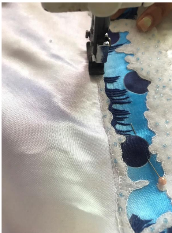
ภาพที่ 147 เย็บผ้าต่วนที่ปักเรียบร้อยติดกับผ้าเนื้อแข็ง
