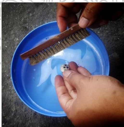
ภาพที่ 63 ทำความสะอาดชิ้นงานทดลองด้วยแปรงทองเหลือง
