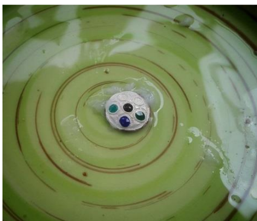
ภาพที่ 62 ชิ้นงานทดลองที่นำไปแช่กรดกำมะถัน
