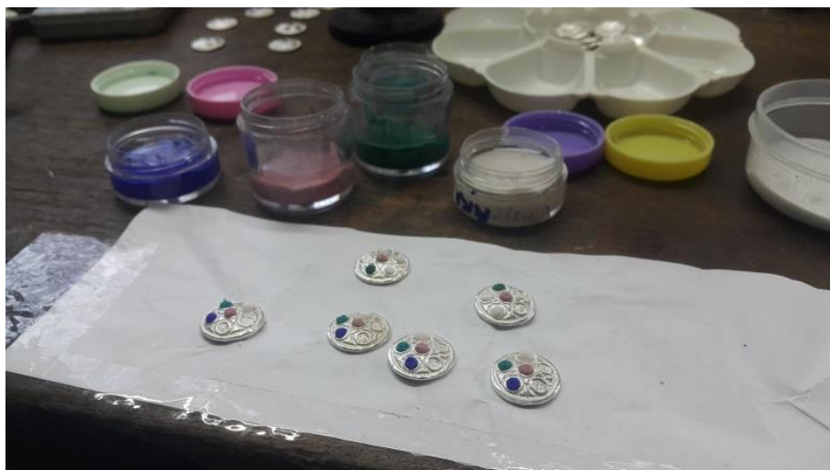
ภาพที่ 60 ชิ้นงานทดลองขณะลงยาสีก่อนนำไปเผาไฟจนหลอมละลาย
