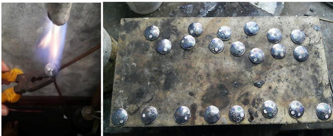
ภาพที่ 64 ชิ้นงานทดลองขณะลงยาอมและรอให้ชิ้นงานเย็นตัวลง
