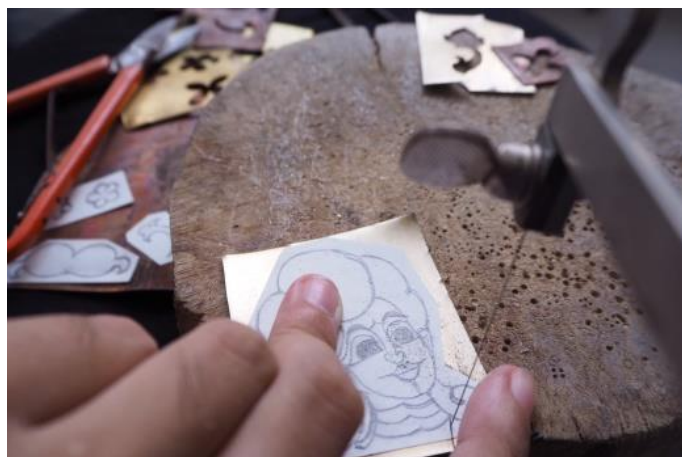
ภาพที่ 35 ฉลุแผ่นโลหะตามลายของตัวทดลอง
