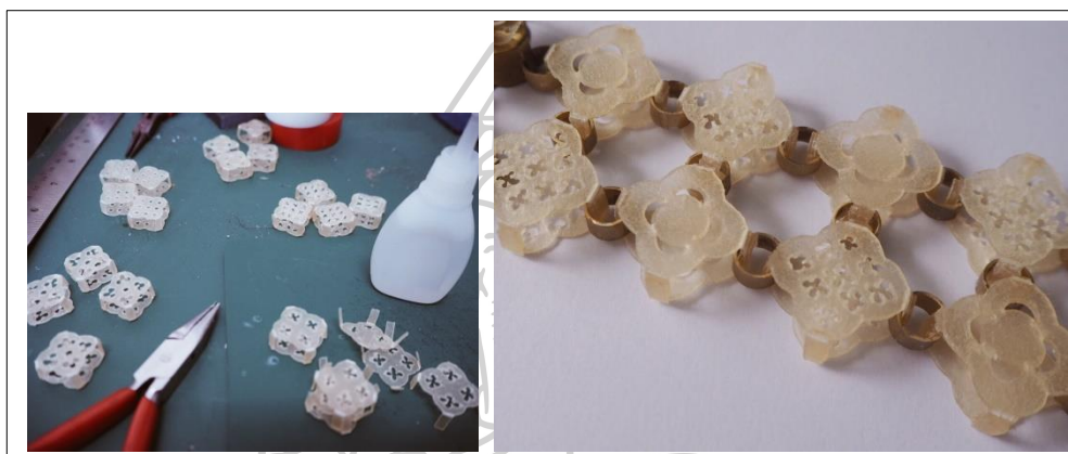
ภาพที่ 83 การประกอบชิ้นส่วนข้อต่อลายดอกจากแผ่นหนัง (สร้อยคอ)
