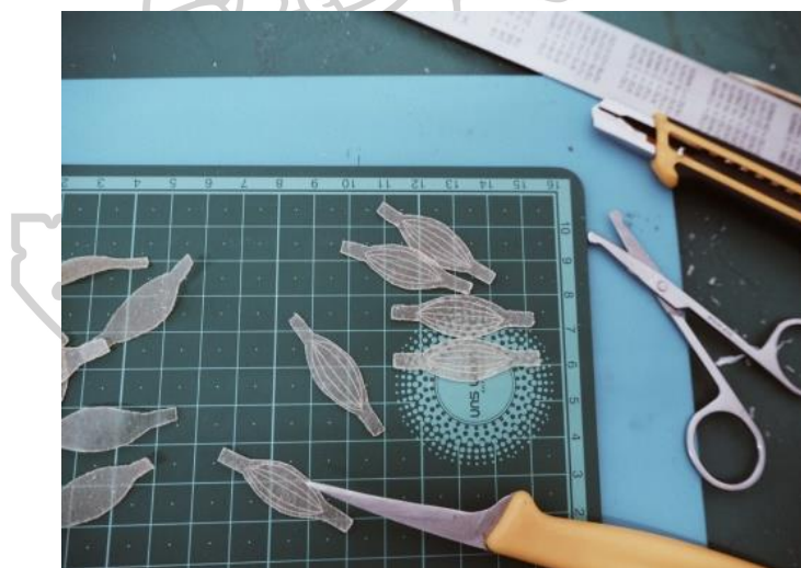
ภาพที่ 67 การจิดลายแผ่นแพทเทิร์นหนังวัว
