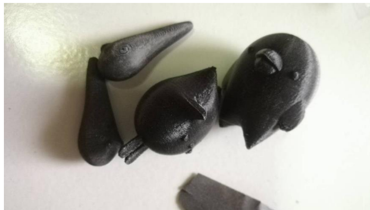
ภาพที่ 62 ภาพโมเดล 3 มิติที่สั่งพิมพ์ก่อนขัดกระดาษทราย
