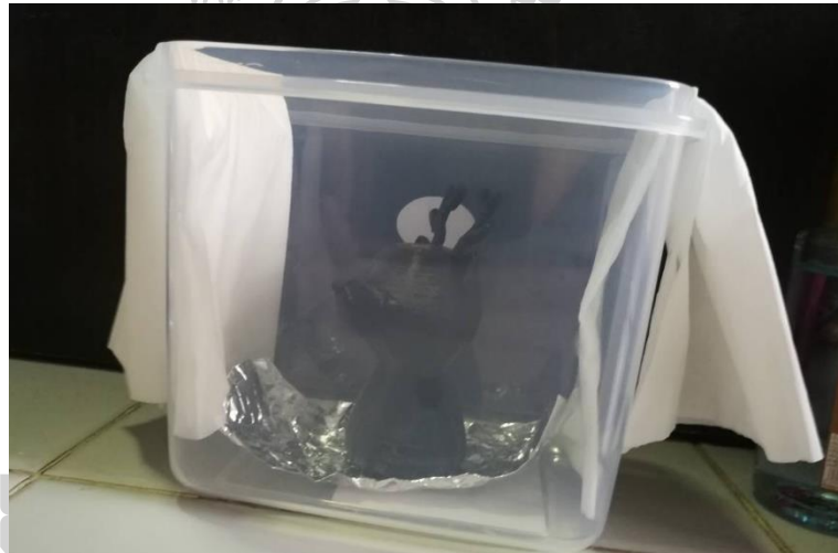
ภาพที่ 61 ภาพทดลองนำโมเดล 3 มิติไปอบฮาซิโตน เพื่อให้ได้พื้นผิวที่เรียบ
