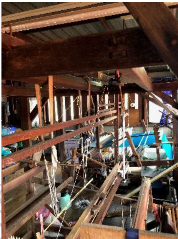
ภาพที่ 59 ที่ทอผ้าที่ใช้ทอผ้าในชุมชนบ้านครัวเป็นประเภทที่กระตุก
