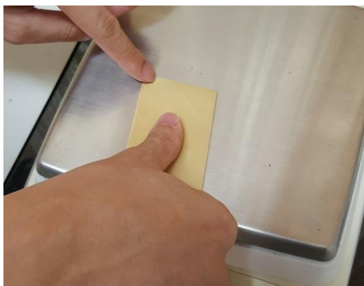
รูปที่ 10 การประทับรอยลายนิ้วมือลงบนด้านเหนียวของเทปกาวตัวอย่าง ใช้แรงกดประมาณ 1,200-1,500 กรัม ค้างไว้ 5 วินาที
