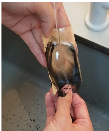
รูปที่ 12 การปล่อยให้ น้ำไหลผ่านเพื่อชะล้างสีส่วนเกินออก จนปรากฏเป็นรอยลายนิ้วมือ
