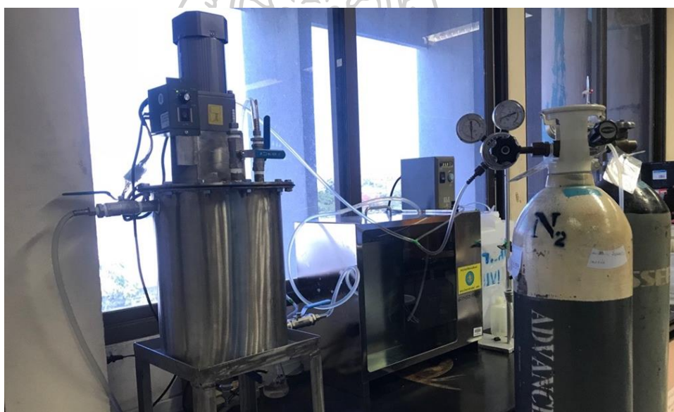
ภาพที่ จ.2. ชุดถังปฏิกรณ์แบบไม่ใช้ออกซิเจนสำหรับบ่มหัวเชื้อจุลินทรีย์เบื้องต้น.
