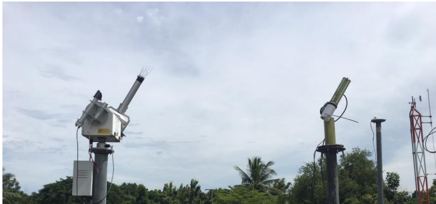
รูปที่ 52 เครื่องชันโฟโตมิเตอร์ที่ติดตั้งบริเวณเดียวกับเครื่องมือที่ผู้วิจัยประยุกต์ขึ้นที่สถานีลพบุรี
