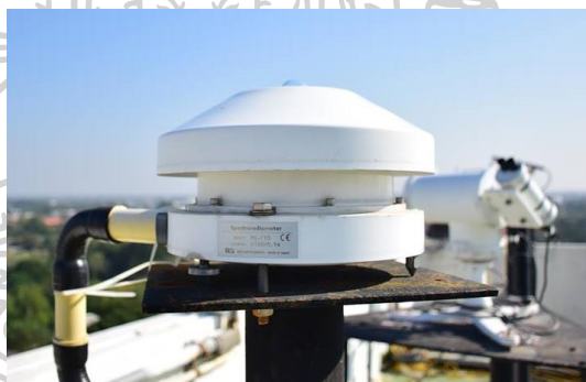
รูปที่ 41 เครื่องวัดสเปกตรัมรังสีรวมของดวงอาทิตย์ที่จะนำมาประยุกต์
