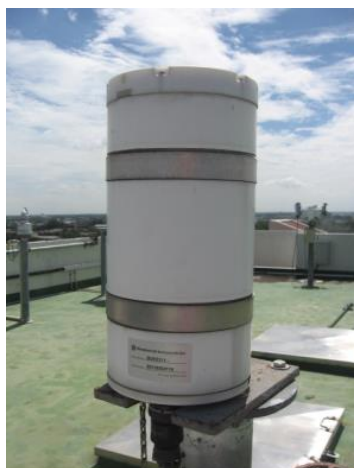
รูปที่ 18 เครื่องวัดความเข้มข้นรังสีอัลตราไวโอเล็ตแบบใช้แผ่นกรองรังสีหลายช่องสัญญาณ
