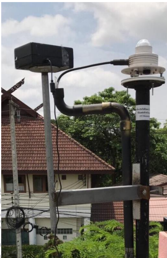
รูปที่ 46 การติดตั้งเครื่องมือวัดรังสีอัลตราไวโอเล็ตที่พัฒนาขึ้น (ด้านซ้าย) เทียบกับ UV-Biometer (ด้านขวา)
