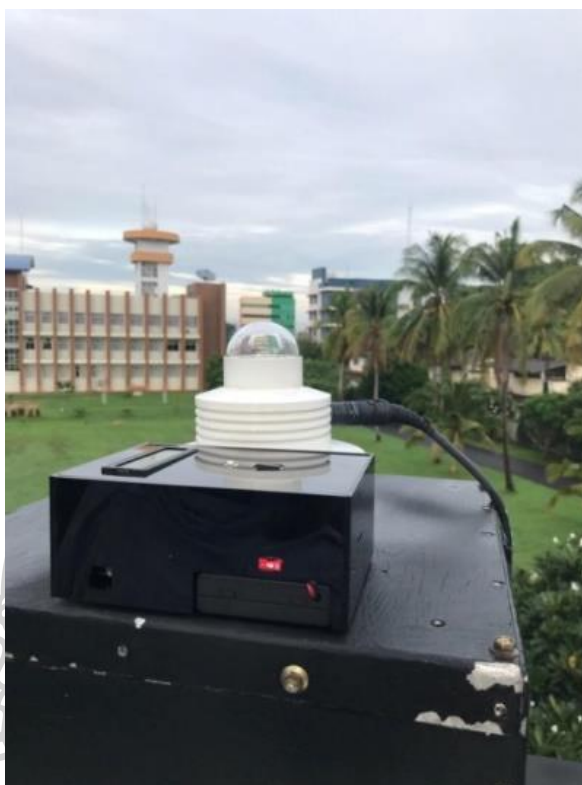
รูปที่ 50 การติดตั้งเครื่องมือวัดรังสีอัลตราไวโอเล็ตที่พัฒนาขึ้น (ด้านซ้าย) เทียบกับ UV-Biometer (ด้านขวา)
