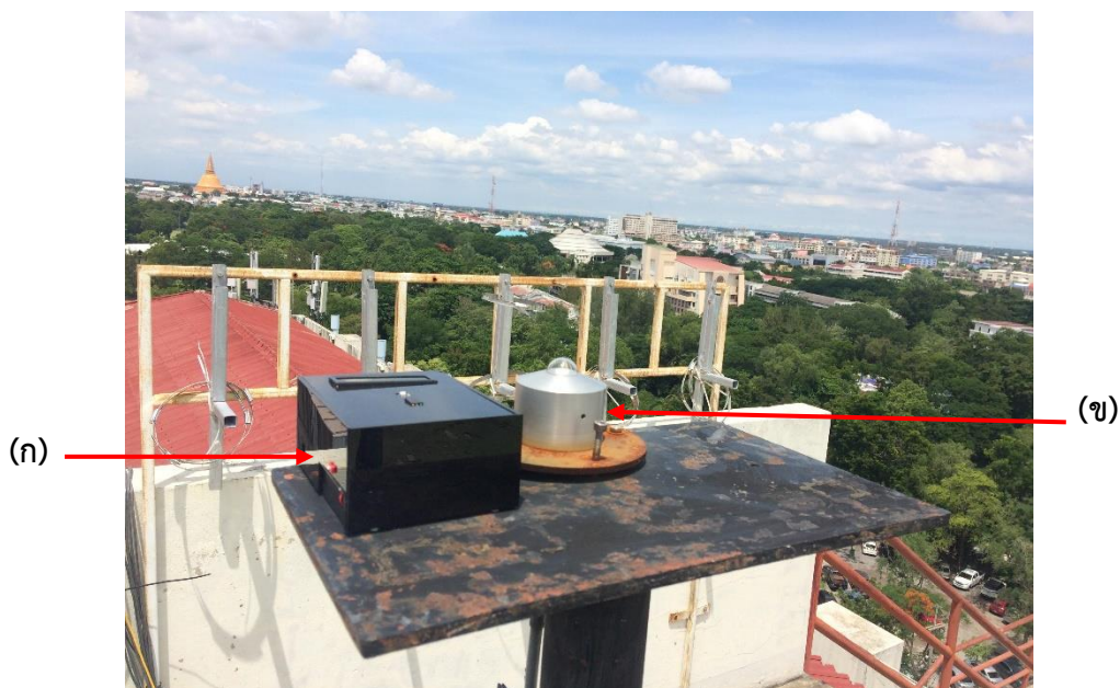
รูปที่ 41 (ก) เครื่องวัดรังสีอัลตราไวโอเล็ตที่พัฒนาขึ้นเทียบกับ (ข) เครื่องวัดสเปกตรัมรังสีอัลตราไวโอเล็ต
