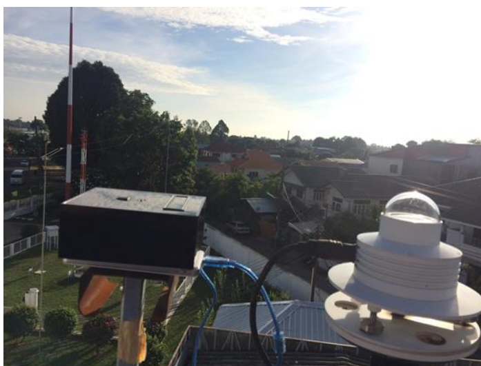
รูปที่ 48 การติดตั้งเครื่องมือวัดรังสีอัลตราไวโอเล็ตที่พัฒนาขึ้น (ด้านซ้าย) เทียบกับ UV-Biometer (ด้านขวา)
