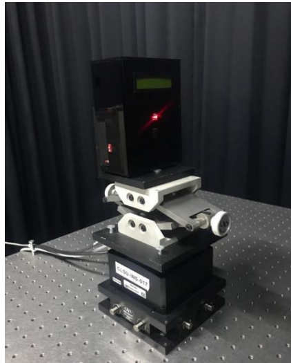
รูปที่ 59 ปรับระดับตำแหน่งของเซนเซอร์ตรงกลางให้อยู่ตรงกลาง
