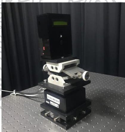
รูปที่ 58 ติดตั้งเครื่องมือวัดรังสีอัลตราไวโอเล็ตที่พัฒนาขึ้นกับชุดอุปกรณ์ปรับมุมแบบละเอียด
