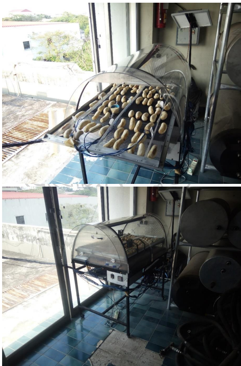
รูปที่ 67 ภาพการทดลองอบแห้งกล้วยน้ำว้าด้วยพลังงานไฟฟ้า
