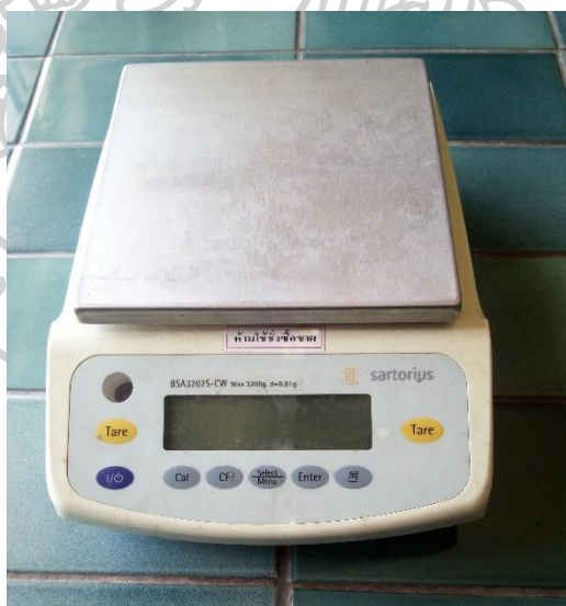
รูปที่ 61 เครื่องชั่งดิจิตอล ยี่ห้อ Sartorius รุ่น BSA
