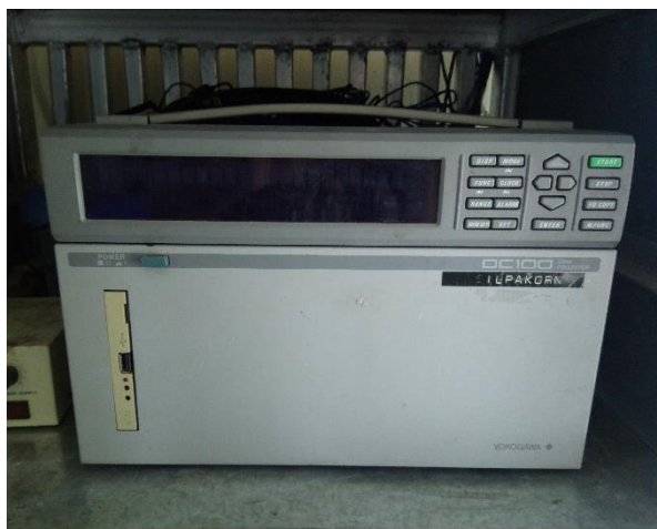
รูปที่ 58 เครื่องบันทึกข้อมูล ยี่ห้อ YOKOGAWA รุ่น DC 100
