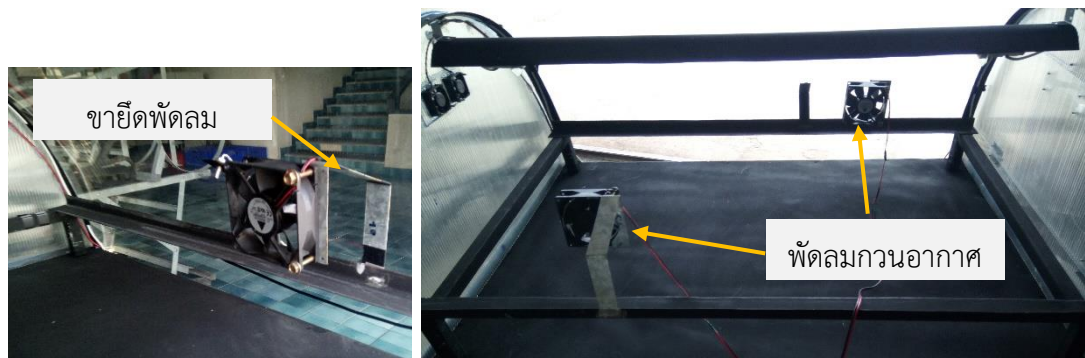
รูปที่ 43 พัดลมกวนอากาศภายในเครื่องอบแห้ง
