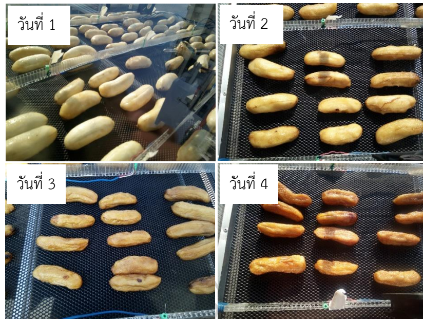
รูปที่ 62 ภาพถ่ายกล้วยน้ำว้าที่อบแห้งในเครื่องอบแห้งโดยใช้พลังงานแสงอาทิตย์ (การทดลองที่ 2)
