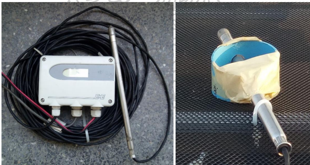
รูปที่ 56 เครื่องวัดความชื้นสัมพัทธ์ ยี่ห้อ E+E ELEKTRONIK รุ่น EE23 (ซ้าย) และหัววัดที่ติดตั้งบนที่ยึด (ขวา)
