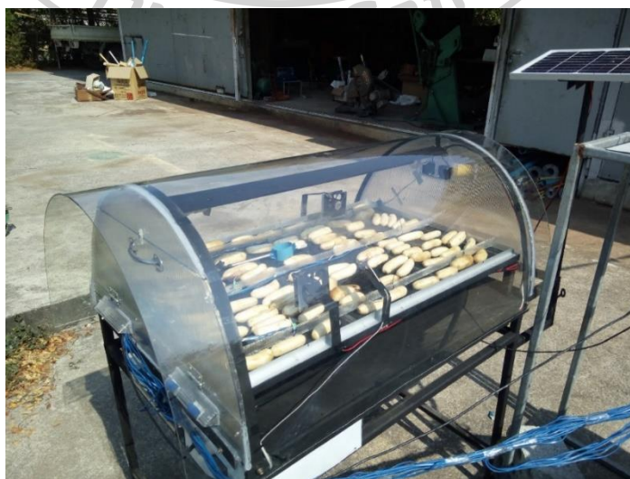
รูปที่ 59 กล้วยน้ำว้าที่อบแห้งด้วยเครื่องอบแห้งพลังงานแสงอาทิตย์
