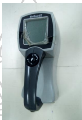
รูปที่ 64 เครื่องวัดสี ยี่ห้อ Hunter Lab รุ่น Miniscan EZ
