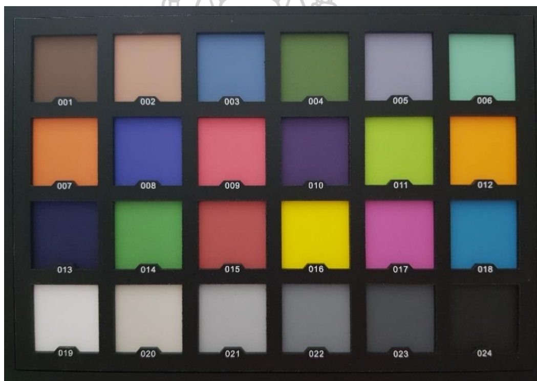
รูปที่ 36 Color Palette สำหรับใช้ทดสอบความคงที่ของสีจากภาพที่ถ่ายโดยอุปกรณ์ที่ใช้ในการทดลอง
