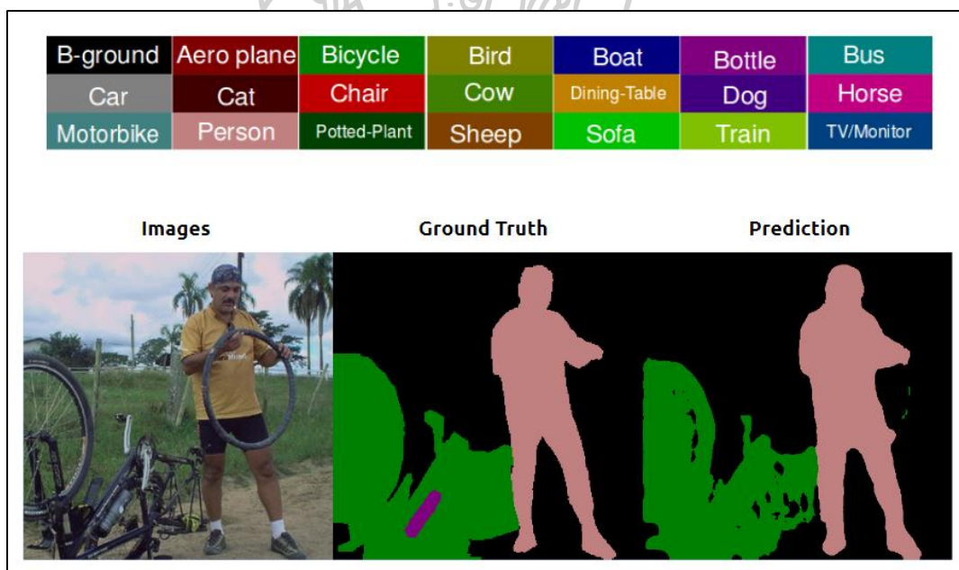
รูปที่ 75 ตัวอย่างการ Segmentation ภาพจากฐานข้อมูล PascalVOC โดยโมเดลจำแนกวัตถุ
