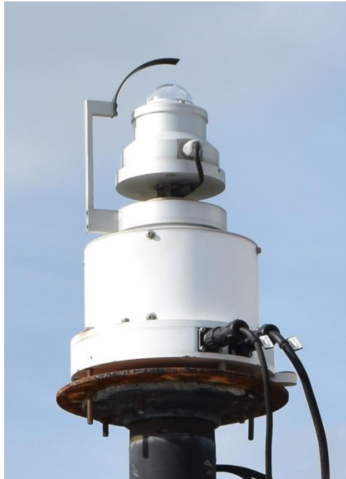
รูปที่ 41 เครื่องถ่ายภาพท้องฟ้า (sky view) ของสถานีสงขลา
