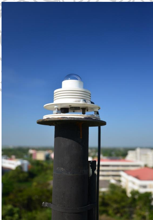
รูปที่ 29 เครื่องวัดความเข้มรังสีรวมในช่วงความยาวคลื่นรังสีอัลตราไวโอเล็ตที่สถานีนครปฐม
