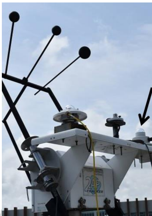
รูปที่ 26 เครื่องวัดความเข้มรังสีกระจายในช่วงความยาวคลื่นรังสีอัลตราไวโอเล็ตที่สถานีสงขลา
