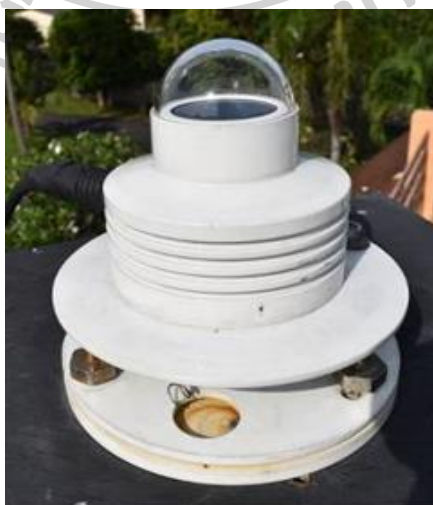
รูปที่ 14 ตัวอย่างเครื่องวัดความเข้มรังสีอัลตราไวโอเล็ตในช่วงความยาวคลื่นกว้าง
