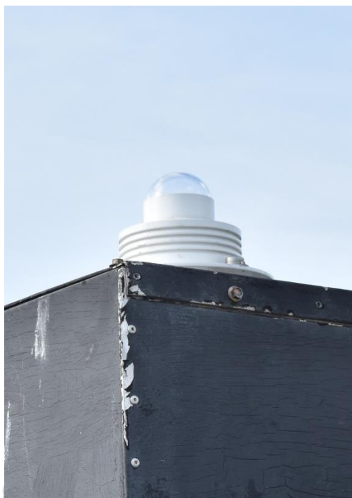
รูปที่ 30 เครื่องวัดความเข้มรังสีรวมในช่วงความยาวคลื่นรังสีอัลตราไวโอเล็ตที่สถานีสงขลา
