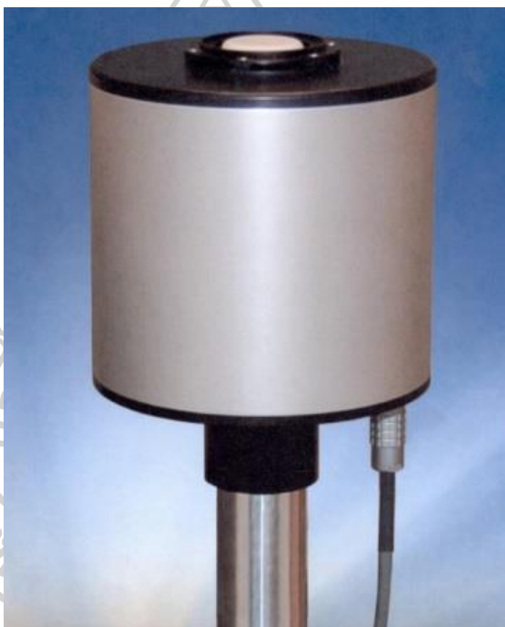
รูปที่ 16 ตัวอย่างเครื่องวัดรังสีอัลตราไวโอเล็ตแบบใช้แผ่นกรองรังสีหลายช่องสัญญาณ NILU-UV (NILU products AS)
