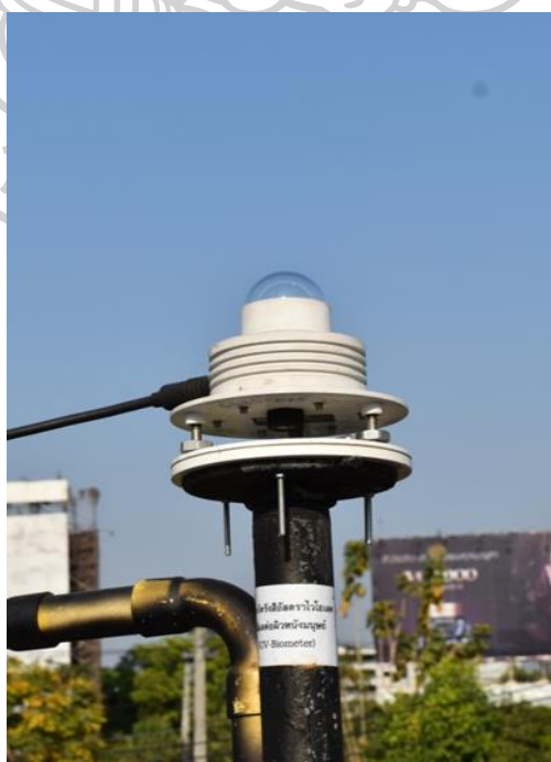
รูปที่ 27 เครื่องวัดความเข้มรังสีรวมในช่วงความยาวคลื่นรังสีอัลตราไวโอเล็ตที่สถานีเชียงใหม่
