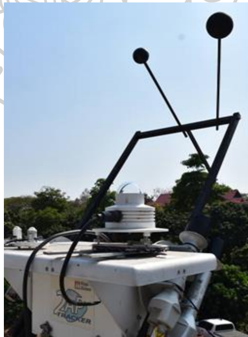
รูปที่ 23 เครื่องวัดความเข้มรังสีกระจายในช่วงความยาวคลื่นรังสีอัลตราไวโอเล็ตที่สถานีเชียงใหม่
