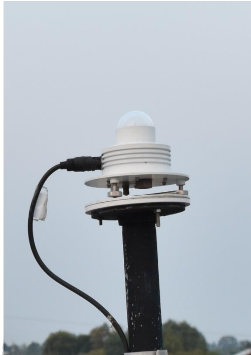
รูปที่ 28 เครื่องวัดความเข้มรังสีรวมในช่วงความยาวคลื่นรังสีอัลตราไวโอเล็ตที่สถานีอุบลราชธานี
