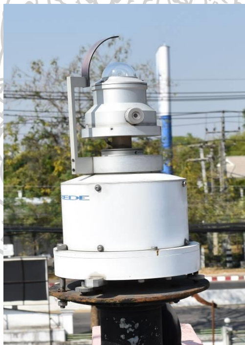
รูปที่ 38 เครื่องถ่ายภาพท้องฟ้า (sky view) ของสถานีเชียงใหม่
