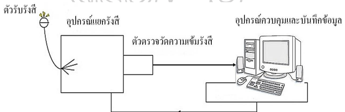
รูปที่ 10 แผนภูมิแสดงองค์ประกอบของเครื่องวัดสเปกตรัมรังสีอัลตราไวโอเล็ตอัลตราไวโอเล็ต
