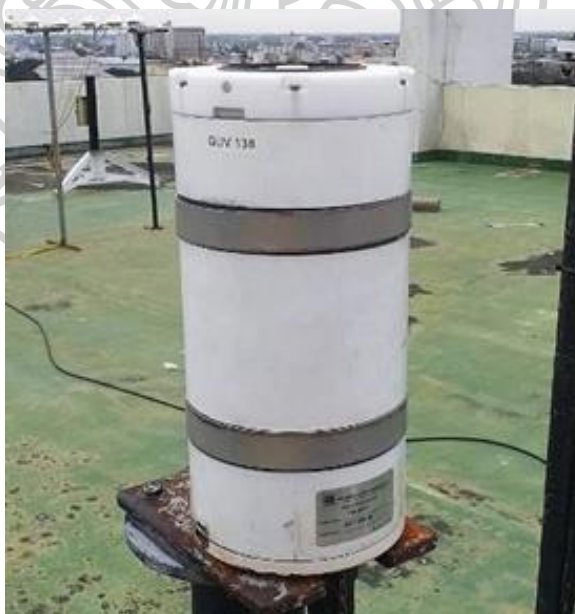
รูปที่ 15 ตัวอย่างเครื่องวัดรังสีอัลตราไวโอเล็ตแบบใช้แผ่นกรองรังสีหลายช่องสัญญาณ
