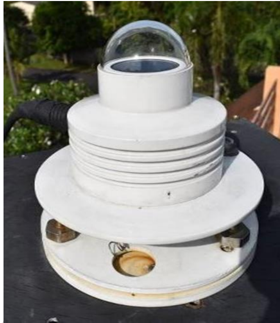
รูปที่ 20 เครื่องวัด UV-Biometer รุ่น 501A ของบริษัท Solar Light ประเทศสหรัฐอเมริกา
