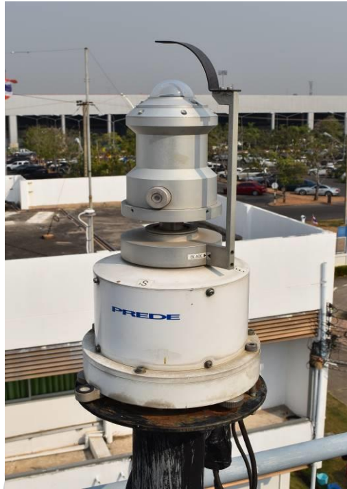
รูปที่ 39 เครื่องถ่ายภาพท้องฟ้า (sky view) ของสถานีอุบลราชธานี
