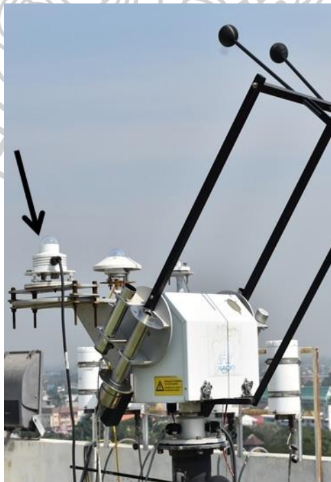
รูปที่ 25 เครื่องวัดความเข้มรังสีกระจายในช่วงความยาวคลื่นรังสีอัลตราไวโอเล็ตที่สถานีนครปฐม
