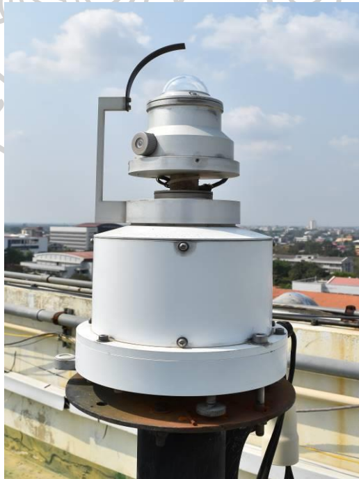
รูปที่ 40 เครื่องถ่ายภาพท้องฟ้า (sky view) ของสถานีนครปฐม
