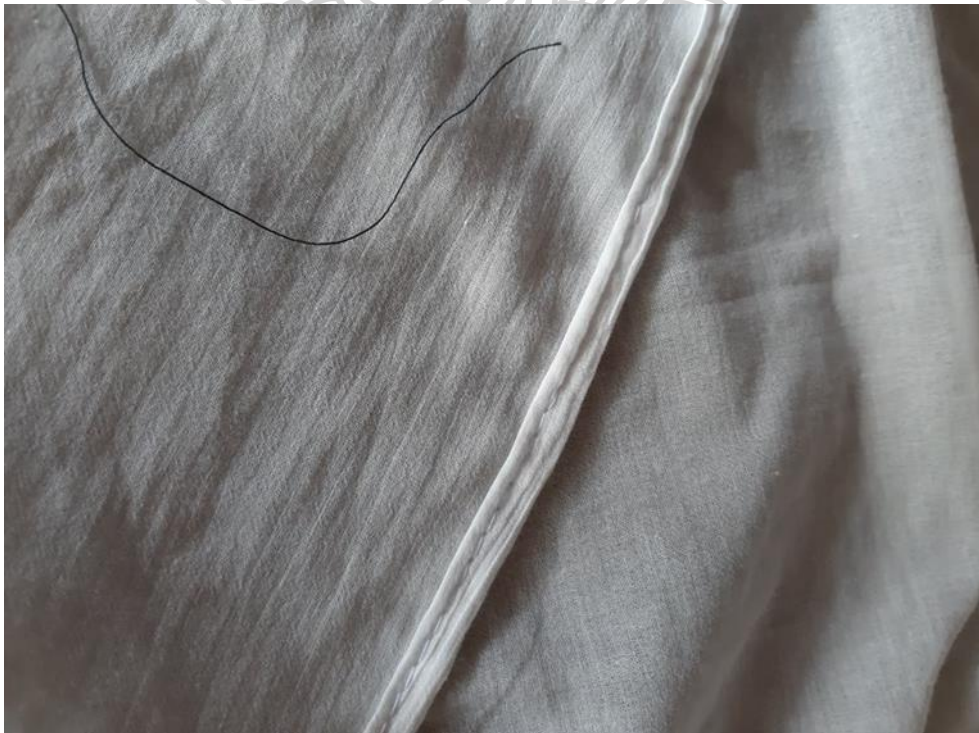
ภาพที่ 27 ขั้นตอนการเย็บขอบผ้า เย็บขอบผ้าโดยใช้ริมผ้าพับทับกัน 3 ครั้ง ให้ได้ขนาดตามที่ต้องการ จากนั้นใช้จักรเย็บผ้าเย็บ
