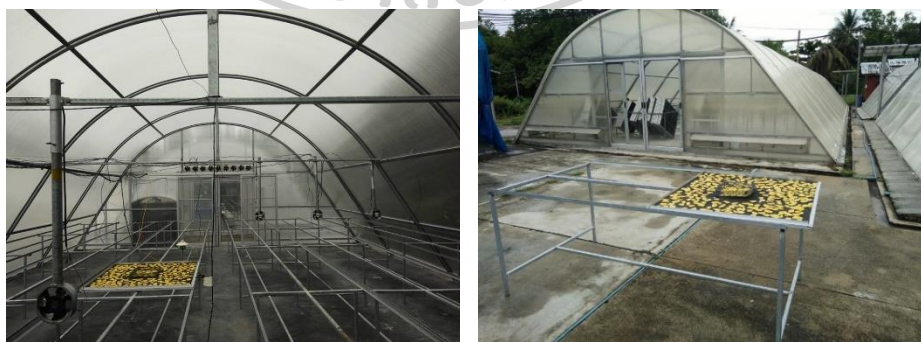
ภาพที่ 19 การทำแห้งไพลด้วยด้วยระบบอบแห้งพลังงานแสงอาทิตย์แบบเรือนกระจกเปรียบเทียบกับการตากแดด
