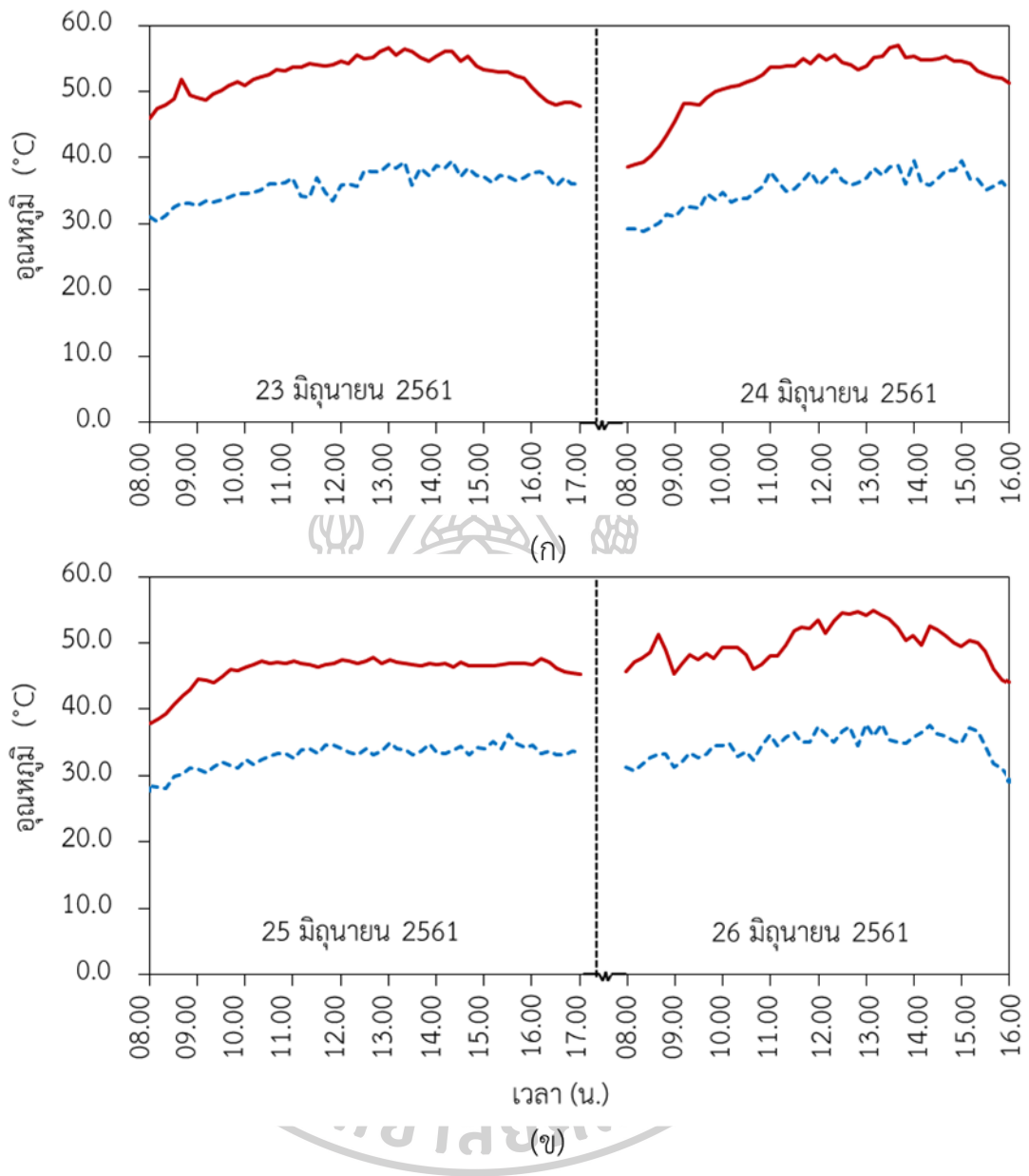
ภาพที่ 32 อุณหภูมิภายในระบบอบแห้งพลังงานแสงอาทิตย์แบบเรือนกระจกและภายนอกของระบบอบแห้งพลังงานแสงอาทิตย์แบบเรือนกระจกหรือการตากแดดของวันที่ทำแห้งไพล สำหรับการทดลองทำแห้งไพลซ้ำที่ 1 (ก) และซ้ำที่ 2 (ข)
