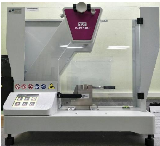
ภาพที่ 3.5 เครื่องทดสอบการกระแทก (Impact tester)
