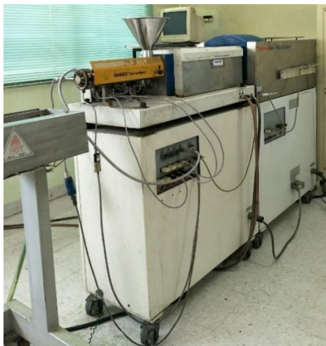
ภาพที่ 3.3 เครื่องอัดรีดแบบสกรูคู่ (Co-rotating twin-screw extruder)
