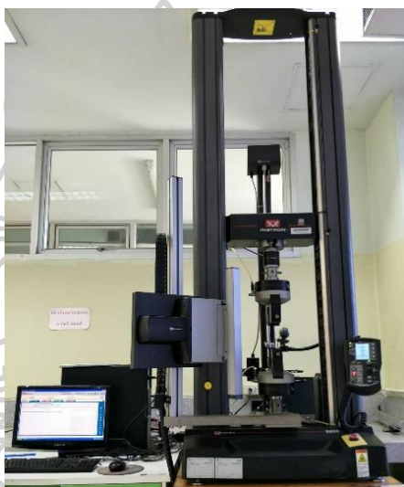
ภาพที่ 3.4 เครื่องทดสอบสมบัติเชิงกลแบบทั่วไป (Universal testing machine)
