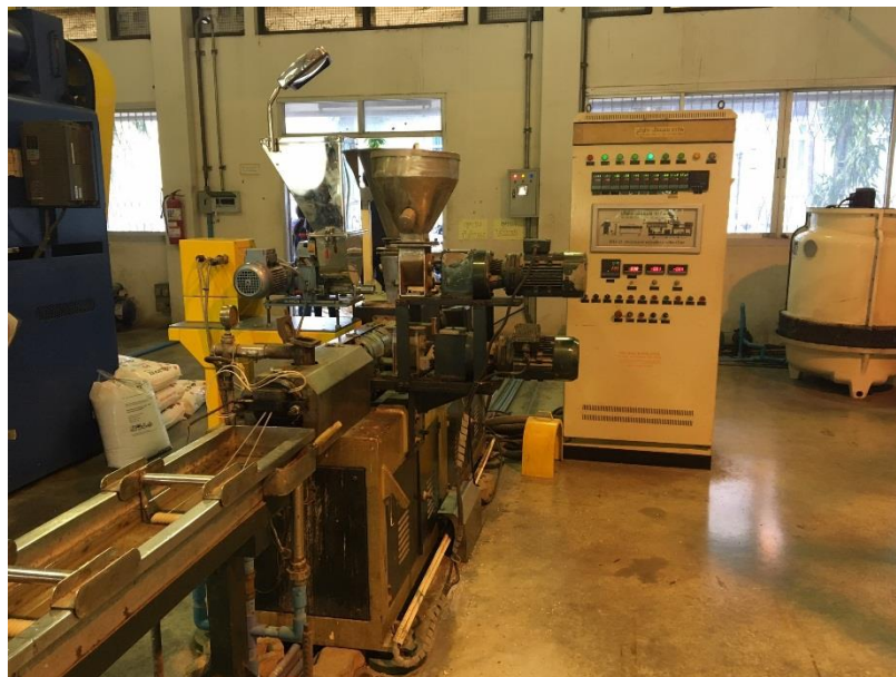
ภาพที่ 3.4 แสดงเครื่องอัดรีดแบบเกลียวทวนอนคู่ (Co-rotating twin screw extruder) จากบริษัท Yongteng ประเทศจีน
