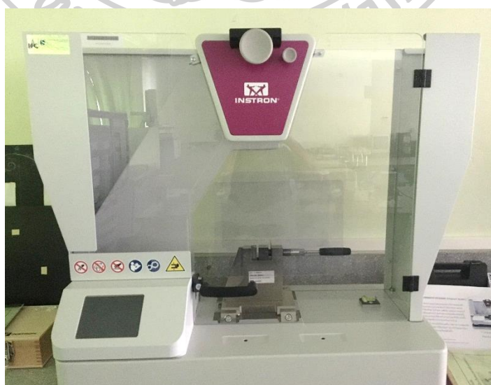
ภาพที่ 3.8 แสดงเครื่องทดสอบความทนต่อแรงกระแทก (Impact testing machine)
