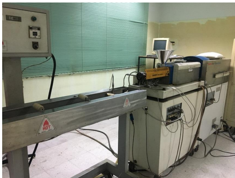
ภาพที่ 3.1 แสดงเครื่องอัดรีดแบบเกลียวทวนคู่ (Co-rotating twin screw extruder) จากบริษัท Haake ประเทศเยอรมัน
