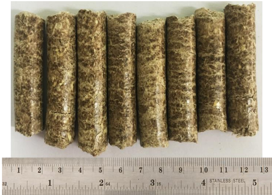
รูปที่ ซ-3 เชื้อเพลิงอัดแท่งตะเกียบจากเศษกระถินผสมเหง้ามันสำปะหลังหมัก 1 วัน
