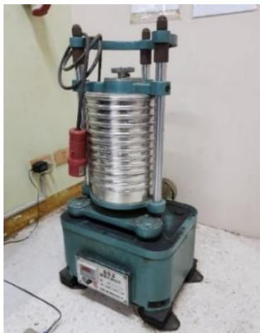
รูปที่ 3.19 เครื่องเขย่าคัดแยกอนุภาค (Sieve Shaker) รุ่น XSZ-200
