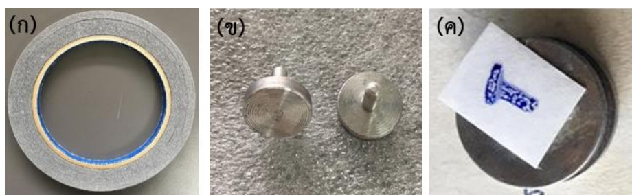
รูปที่ 3.22 (ก) เทปกาวคาร์บอน, (ข) ฐานอะลูมิเนียม (Stub) และ (ค) เทปกาวคาร์บอนที่แปะลงบน ฐานอะลูมิเนียม
