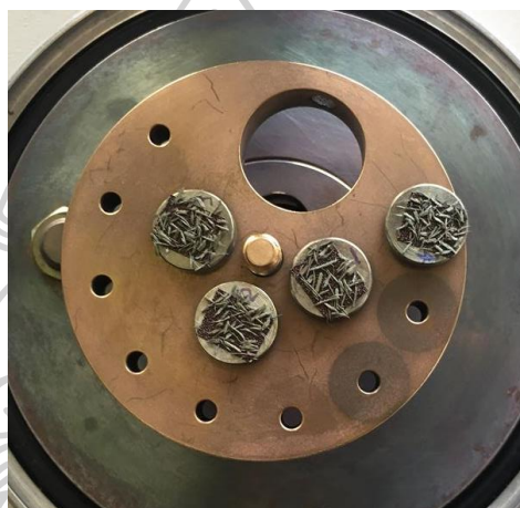
รูปที่ 3.25 ซิวมวลที่ผ่านการเคลือบทองโดยเครื่องเคลือบทอง Sputter coater
