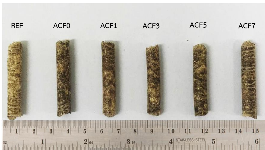
รูปที่ 4.1 เชื้อเพลิงอัดแท่งตะเกียบจากเศษไม้กระถิน (REF) และเชื้อเพลิงอัดแท่งตะเกียบจากเศษไม้กระถินผสมเหง้ามันสำปะหลังหมักที่ระยะเวลา 0, 1, 3, 5 และ 7 วัน (ACF0, ACF1, ACF3, ACF5 และ ACF7)
