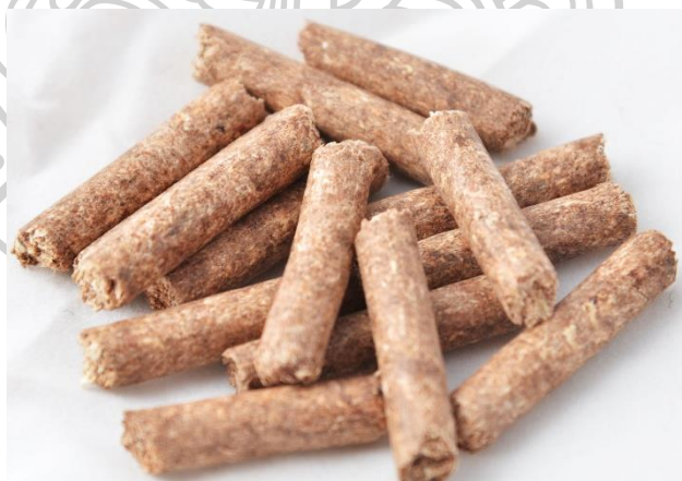
รูปที่ 2.5 เชื้อเพลิงชีวมวลอัดแท่งตะเกียบ
