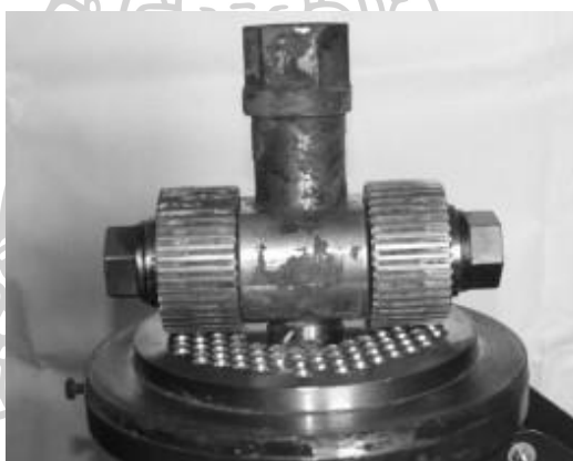
รูปที่ 2.7 เครื่องขึ้นรูปเชื้อเพลิงอัดแท่งโดยการอัดแบบสมบูรณ์
