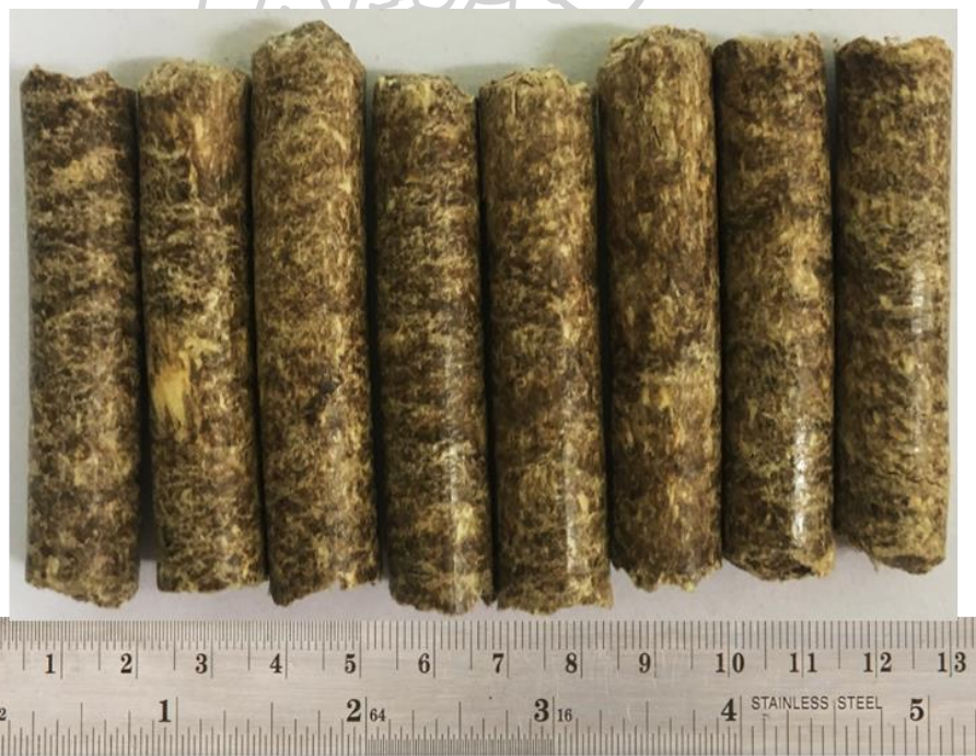
รูปที่ ซ-4 เชื้อเพลิงอัดแท่งตะเกียบจากเศษกระถินผสมเหง้ามันสำปะหลังหมัก 3 วัน
