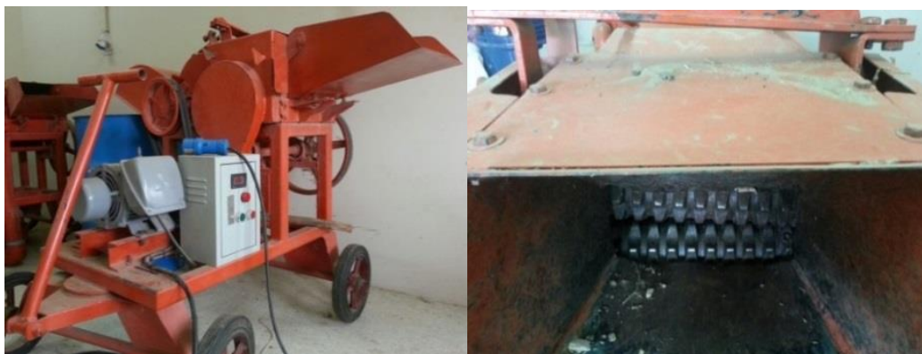
รูปที่ 3.5 เครื่องสับหยาบ และส่วนที่ป้อนชีวมวลเข้าเครื่องสับหยาบ
