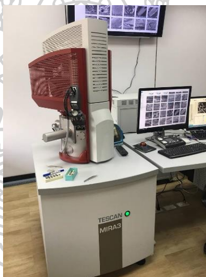
รูปที่ 3.18 เครื่องถ่ายภาพ Scanning electron microscope ยี่ห้อ Test scaw รุ่น Mira 3
