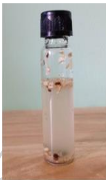
รูปที่ 3.15 ตัวอย่างวัตถุบิส 1 กรัมในสารละลาย 0.89% NaCl (10 มิลลิลิตร)
