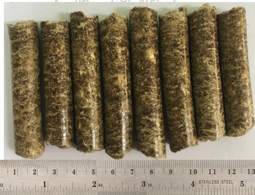
รูปที่ ซ-2 เชื้อเพลิงอัดแท่งตะเกียบจากเศษกระดาษผสมเหง้ามันสำปะหลังไม่ผ่านกระบวนการหมัก
