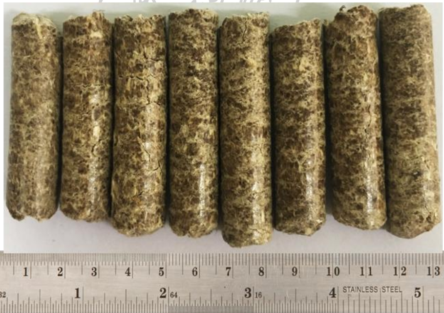
รูปที่ ซ-6 เชื้อเพลิงอัดแท่งตะเกียบจากเศษกระถินผสมเหง้ามันสำปะหลังหมัก 7 วัน
