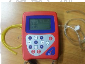
รูปที่ 3.20 เครื่องมือวัดองค์ประกอบก๊าซชีวภาพ
