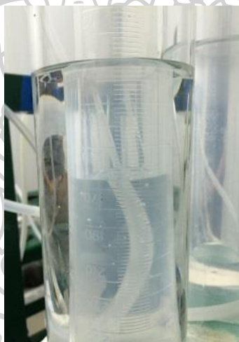
รูปที่ 3.18 การวัดปริมาตรการเกิดก๊าซทั้งหมด โดยเครื่องวัดปริมาตรก๊าซแบบแทนที่น้ำ
