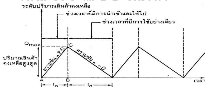
รูปที่ 9 ระบบสินค้าคงเหลือเมื่อการส่งสินค้าที่สั่งซื้อเข้าไม่พร้อมกันทั้งหมด ที่มา: [11] Mason Remy. (2014). การจัดการสินค้าคงคลัง . ค้นหาววันที่ 6 ตุลาคม 2561 แหล่งที่มา https://www.slideserve.com/mason/3
