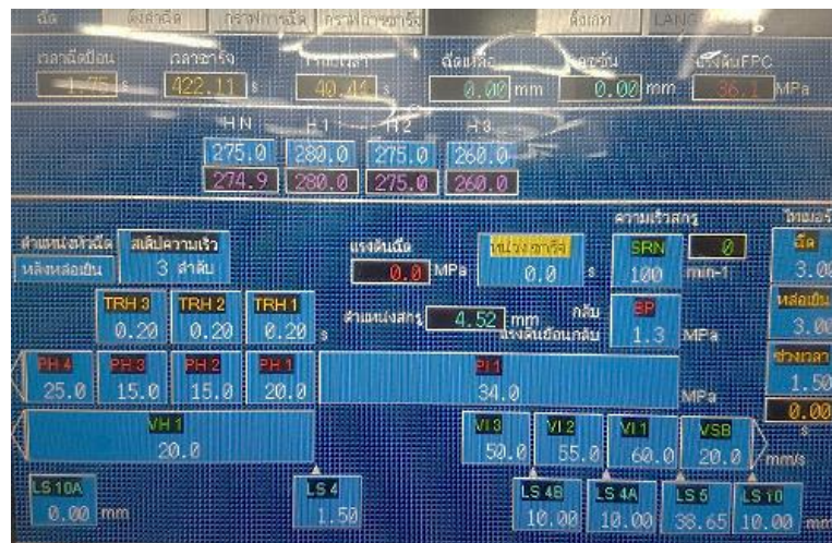
ภาพที่ 63 การตั้งค่าอุณหภูมิในการฉีด HN (Injection Temperature) และการตั้งค่าแรงดันฉีด PI1 (Injection Pressure)
