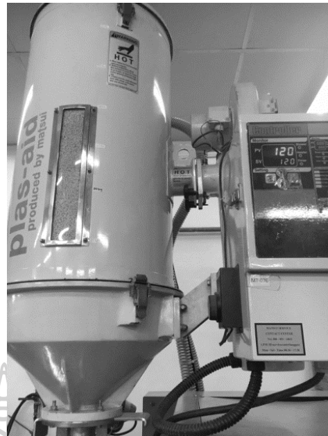
ภาพที่ 65 การตั้งค่าอุณหภูมิในการอบเม็ดพลาสติก (Drying Temperature)
