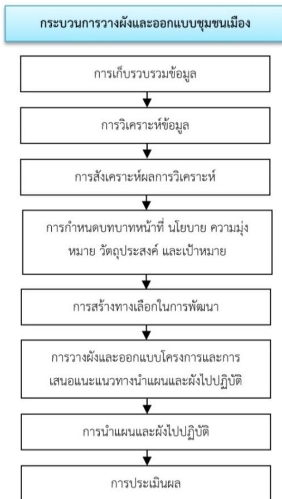
ภาพที่ 12 แบบจำลองกระบวนการวางผังออกแบบชุมชนเมือง ที่มา : ปรับปรุงจากแบบจำลองของ สิทธิพร ภิรมย์รัตน์ การวางแผนกับการวางผัง, 2526
