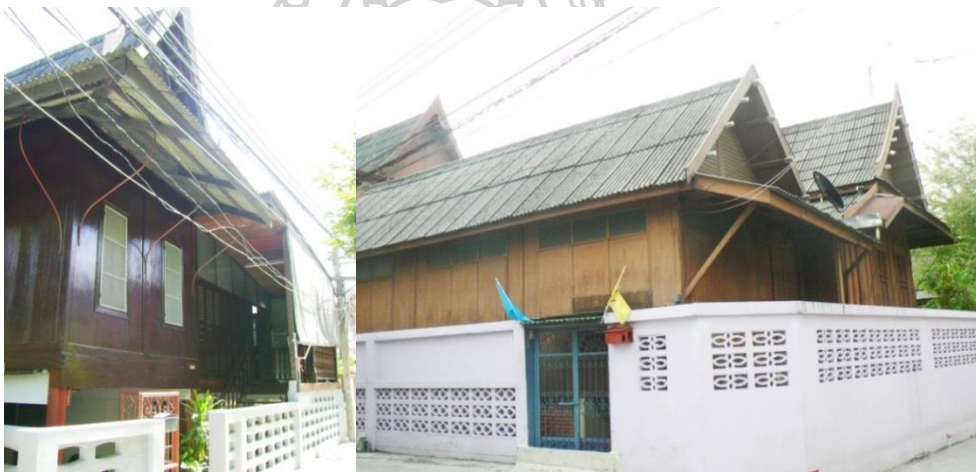
ภาพที่ 33 ใต้ถุนเรือนต่ำกว่าระดับถนนทำให้พื้นที่ชั้น 2 ไกลเคียงกับความสูงรั้ว
