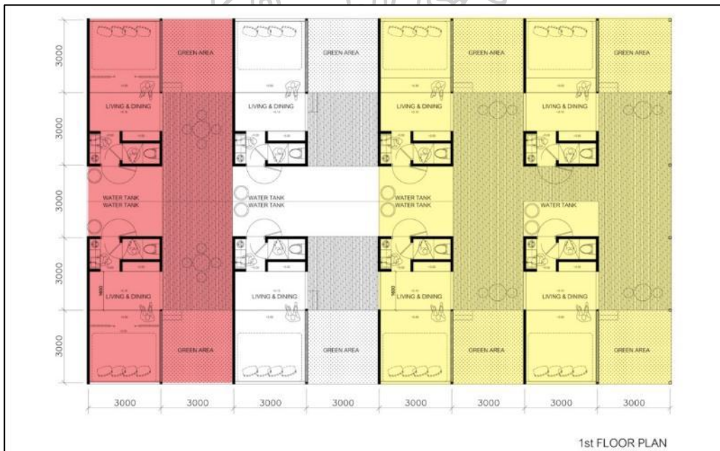
ภาพที่ 157 แสดงผังพื้นที่กลุ่มที่พักอาศัย 2 ครอบครัวและ 4 ครอบครัว
