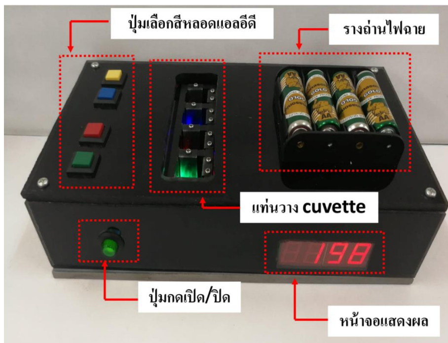
รูปที่ 4.32 เครื่องต้นแบบคัลเลอริมิเตอร์แบบพกพาที่ประดิษฐ์ขึ้นในงานวิจัยนี้
