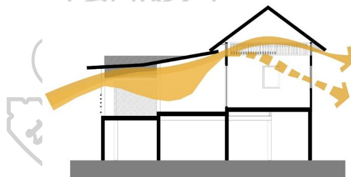
กรณีระบายอากาศด้วยหน้าต่างและช่องเปิดใต้หลังคา
