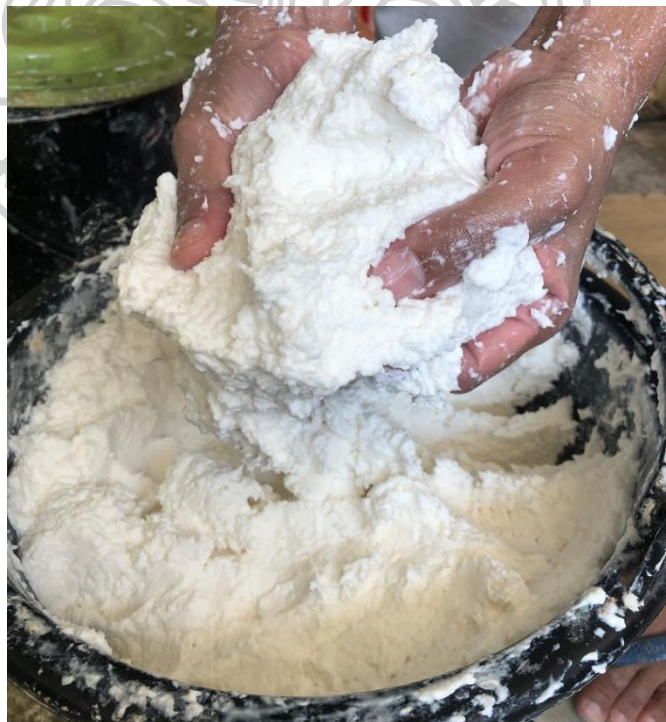
ภาพที่ 62 ขั้นตอนการคลุกเคล้ากาวและเยื่อกระดาษให้เข้ากัน
