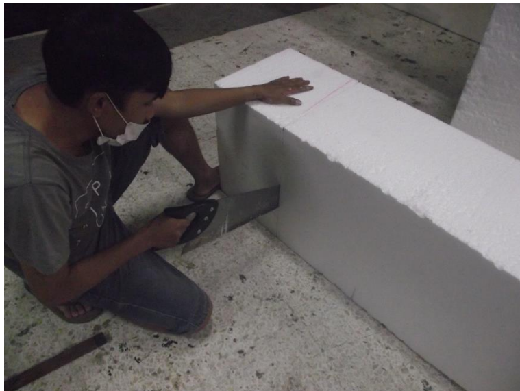
ภาพที่ 47 วิธีการหั่นก้อนโฟมด้วยเลื่อยให้ได้ตามขนาดที่ต้องการ
