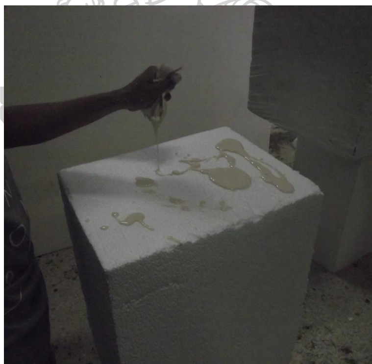
ภาพที่ 48 นำก้อนโฟมมาประกอบเชื่อมด้วยยูนิเทนโฟมจนได้รูปทรงที่ต้องการ
